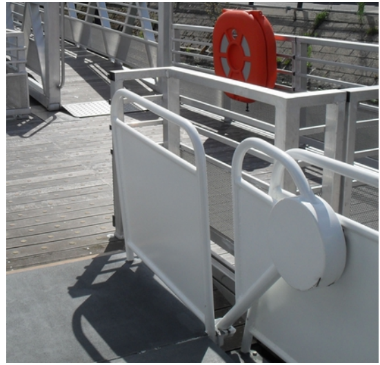
La rampe articulée de la navette à Calais
