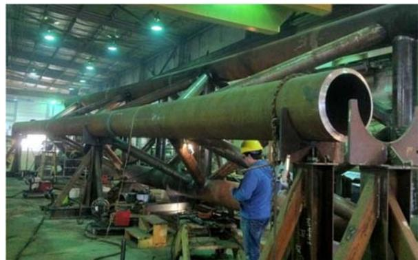
**Fabrication des arches en usine**
