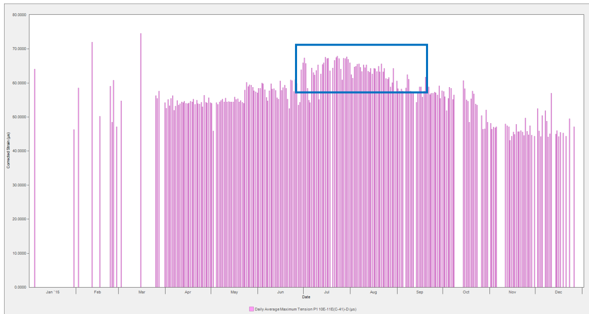
Graphique 5 : P1 10E-11E, augmentation des déformations maximales enregistrées quotidiennement en raison du camionnage du groupe SSL
