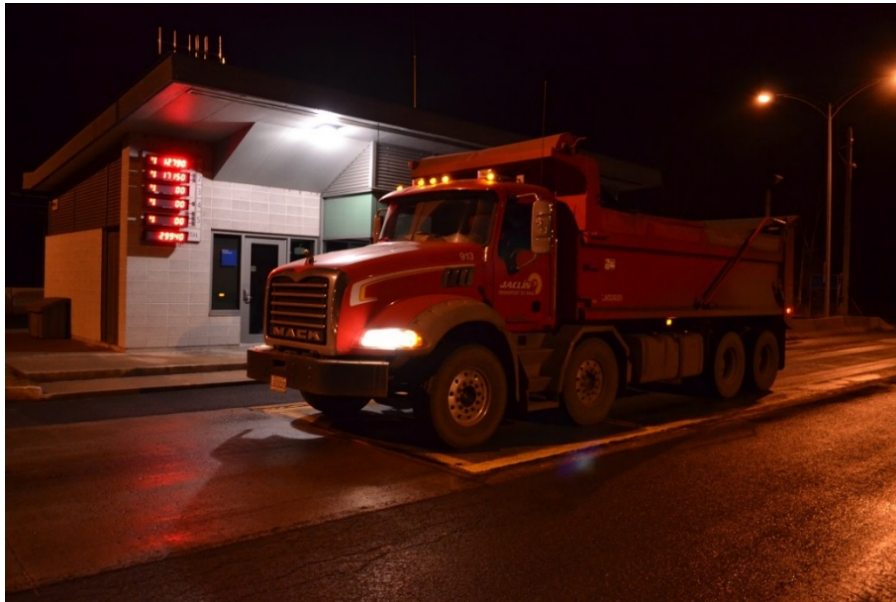
Image 4 : Pesée du camion de 30 Tonnes utilisé lors des tests de charge
