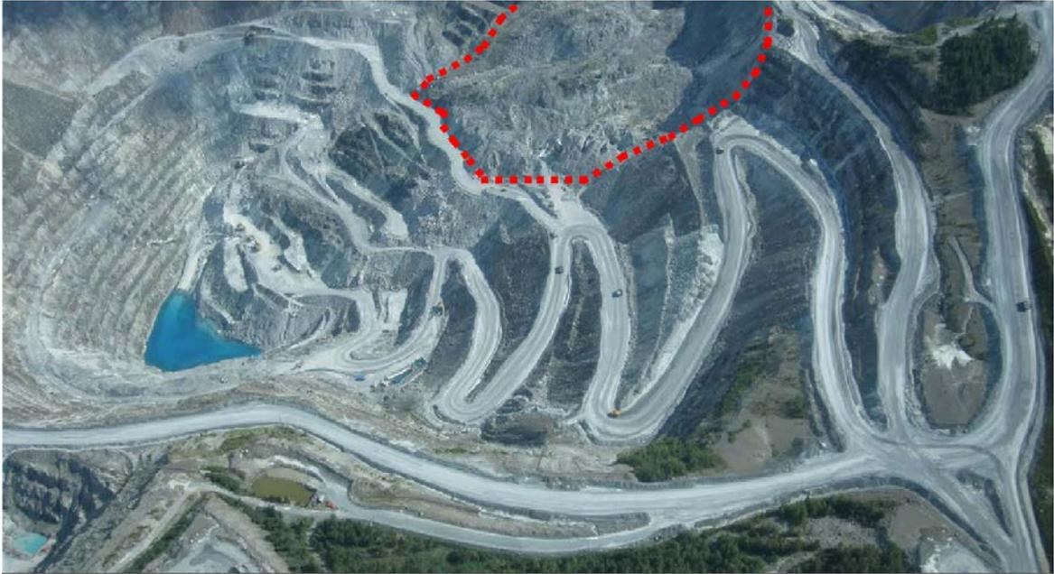
Figure 3-5 Extension du glissement de 2010 sur une vue aérienne oblique (<http://static.panoramio.com>).
