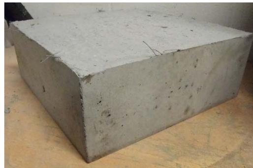
**Figure 38 – Surfaces du spécimen coulé (BRF35-FA-0.5% avec section de treillis soudé) après décoffrage**
