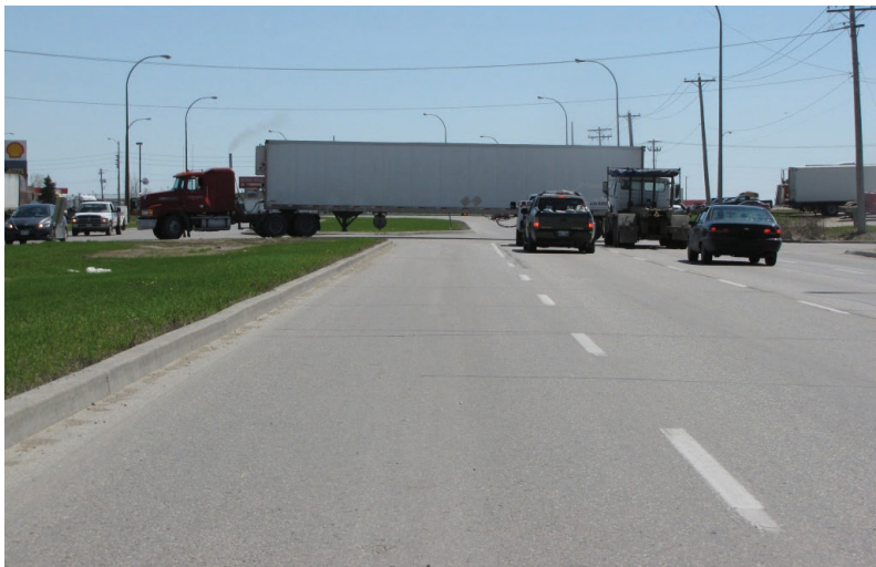
Figure 4.21 : Camion obstruant des voies pendant un virage
