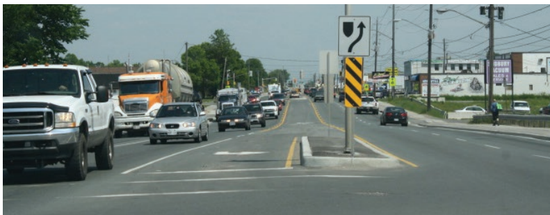
Figure 4.17 : Voies rétrécies et voies ayant été marquées à nouveau pour augmenter la capacité
