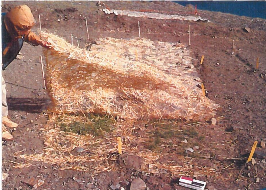
PHOTO 40: Mélanges # 1 (à gauche) et # 2 (à droite) avec fertilisant (F1) et paillis. Densité élevée, recouvrement supérieur à 50% (1 PF1 et 2 PF1)
