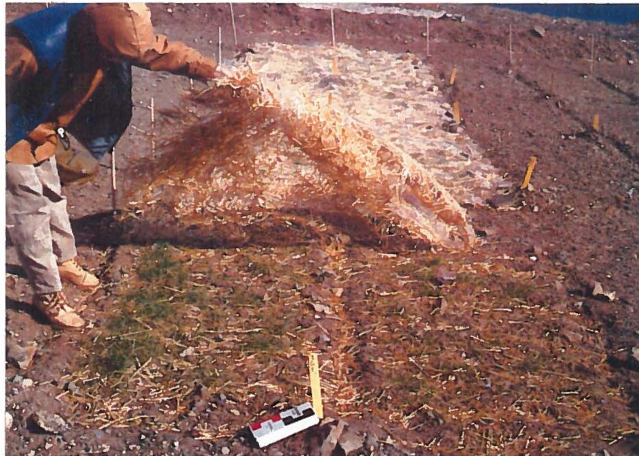
PHOTO 41: Mélanges # 1 (à gauche) et # 2 (à droite) avec paillis, fertilisant (F1) et pré-germination. Densité élevée, recouvrement supérieur à 50% (1 PGF1 et 2 PGF1)
