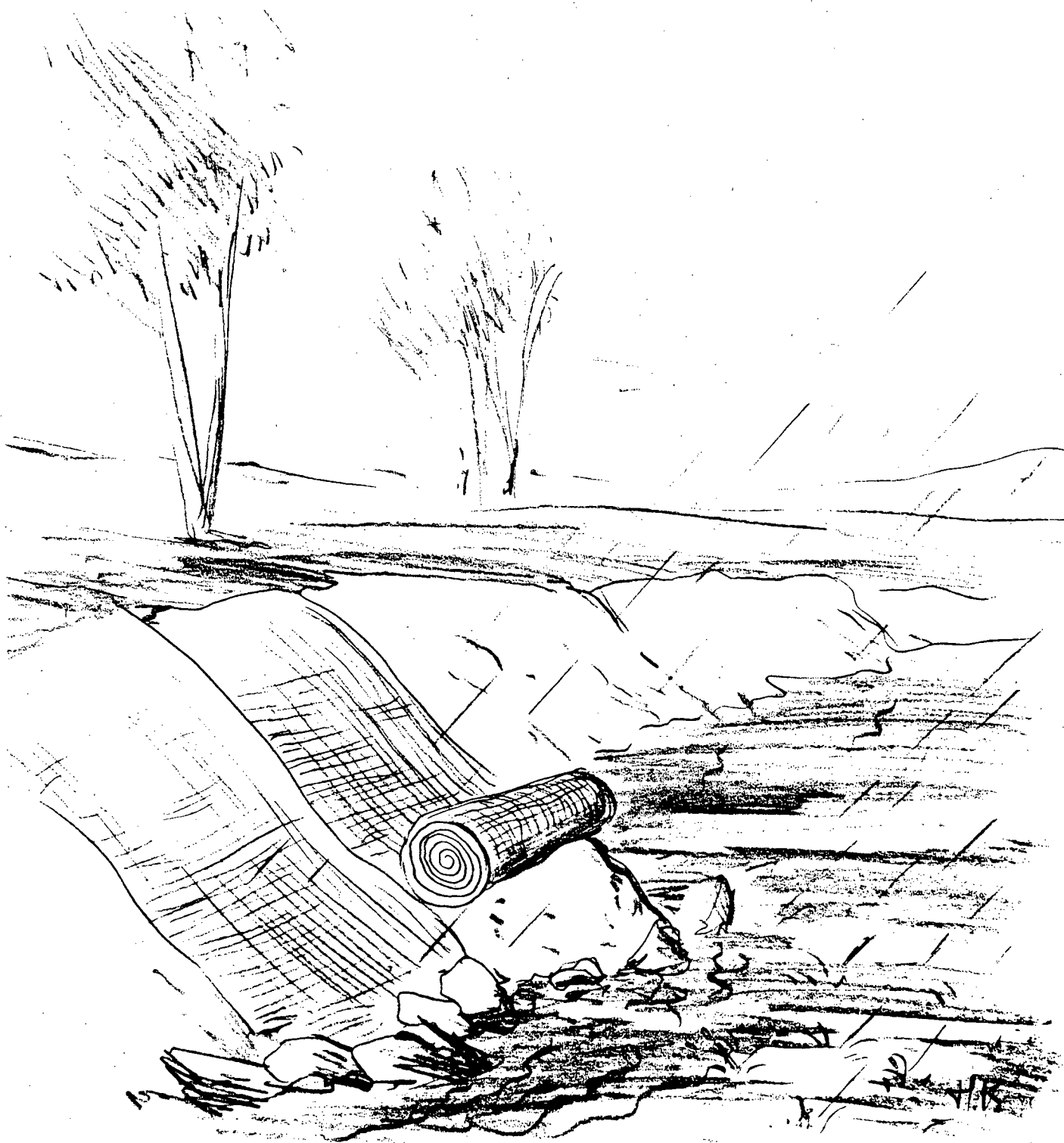
FIGURE 8: UTILISATION DE ROULEAUX DE PAILLASSON POUR LA STABILISATION TEMPORAIRE DES SURFACES DÉBLAYÉES EN BORDURE DE COURS D'EAU
