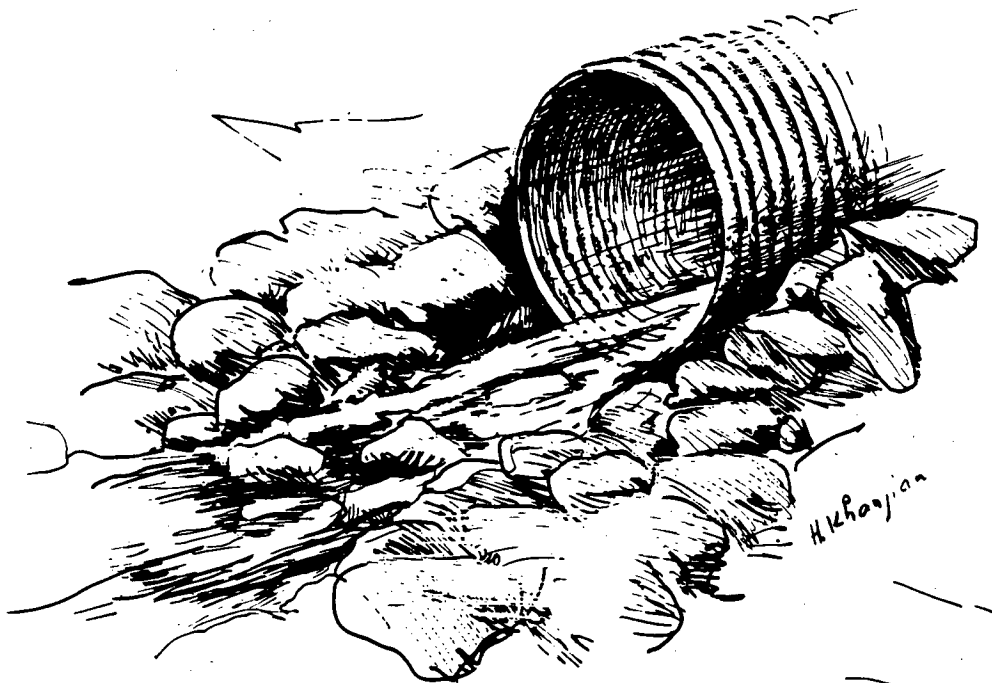
FIGURE 14 : Déversement d'enrochement pour combler une rupture de pente à la sortie d'un ponceau.
