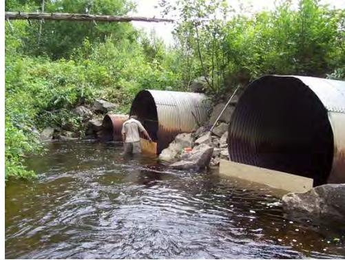
**Figure 12 : Système permettant de faire varier le débit dans a) une section du ponceau; b) un ponceau à trois tuyaux**
