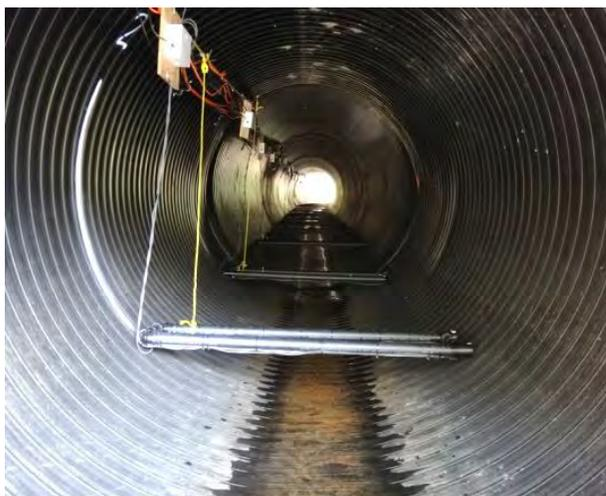
**Figure 14 : Système PIT à haute résolution spatiale**
