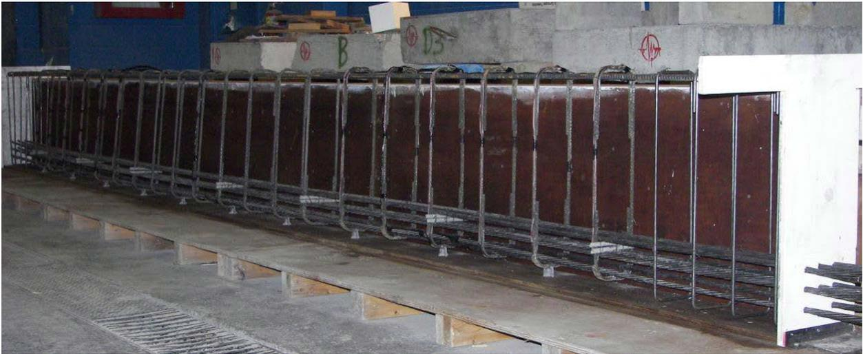
Figure 8 – Détails d'armatures de la poutre SC-9,5-2
