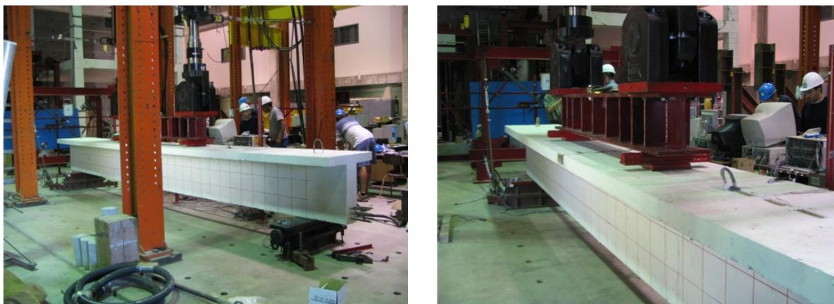
Figure 2.4 – Dispositif d'essai – Poutre SC9.5-2
