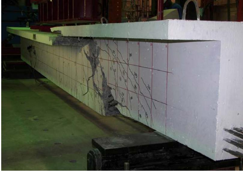
Figure 19 – Poutre SC-9,5-2 après la rupture en cisaillement
