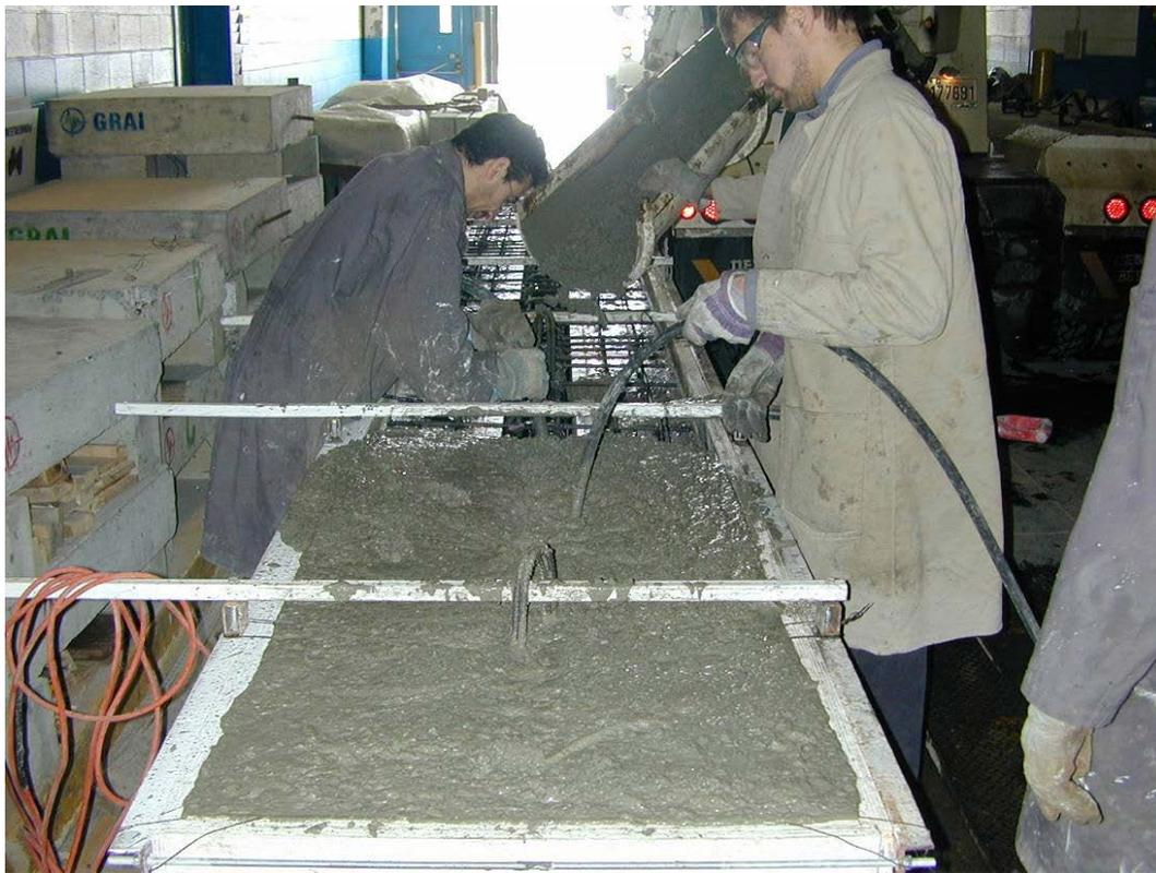
Figure 13 – Coulage de la poutre SC-9,5-3
