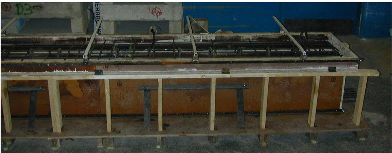
Figure 9 – Détails d'armatures de la poutre SC-9,5-3 (Mi-portée)
