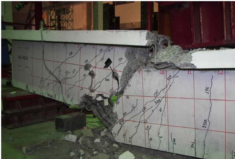
Figure 20 – Poutre SC-9,5-3 après la rupture en cisaillement
