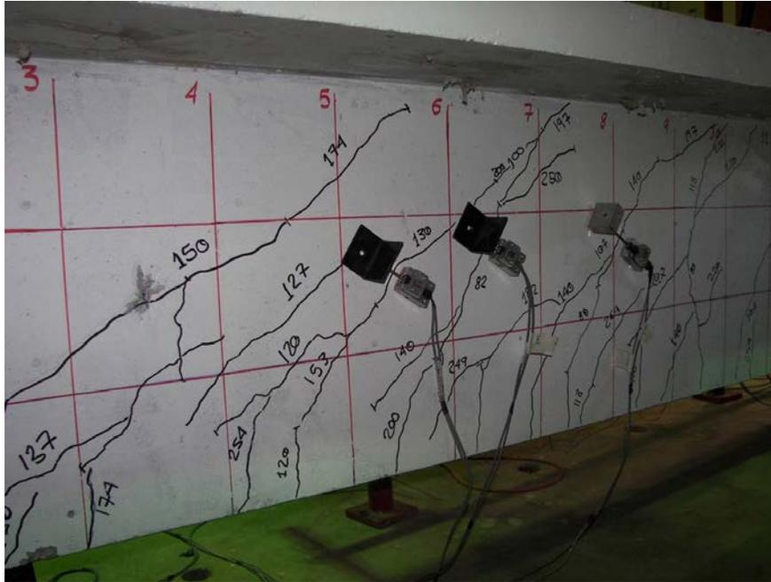
Figure 18 – Mesure de la largeur des fissures avec les LVDT
