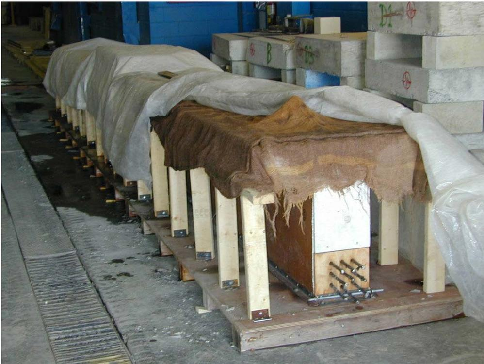
Figure 15 – Cure de poutre SC-9,5-3 après la coulée
