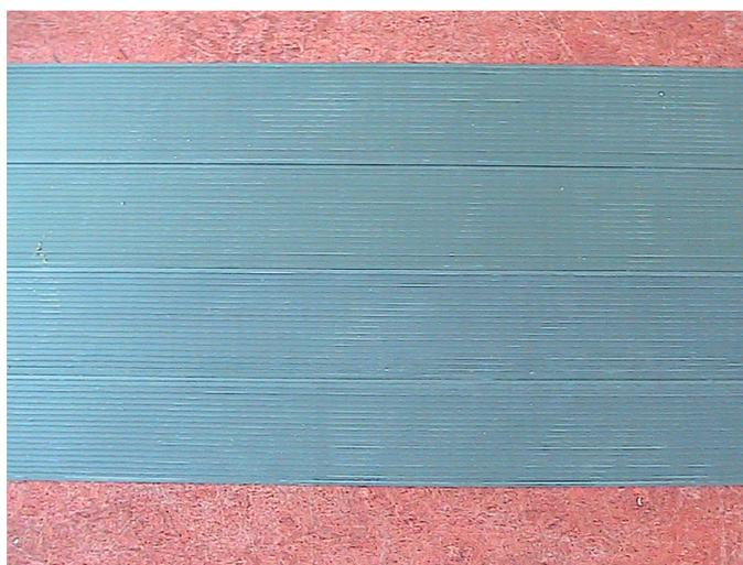
Dans l'état actuel des connaissances, les expérimentations ne permettent pas de proposer des caractéristiques des modules multinervures autres que celles testées, soit une hauteur de 3 mm et une largeur minimum de 110 mm.
