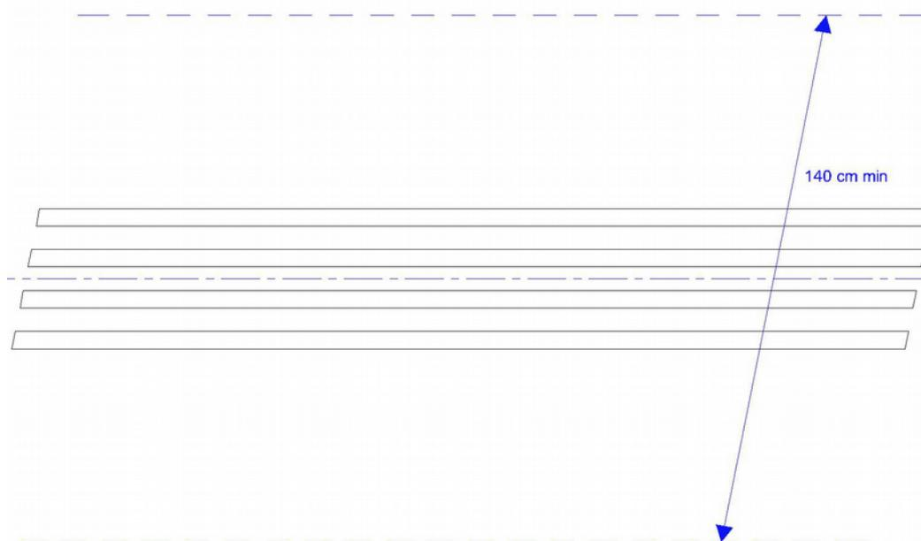
L'axe des modules de guidage est positionné de manière à permettre le passage aisé d'une PAM et de son chien hors de tout obstacle.
