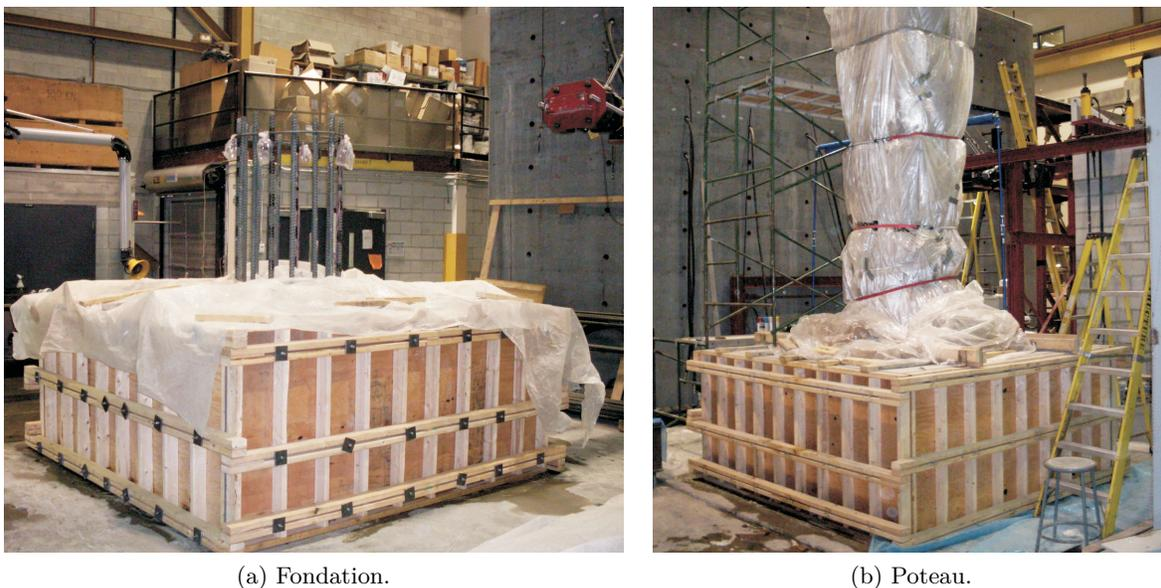
FIGURE 3.6 – Mûrissement du spécimen CH300.
