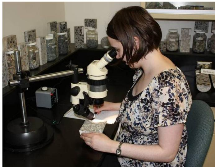
Figure 3.5 : Examen de plaques polies au stéréomicroscope pour la détermination du DRI.
