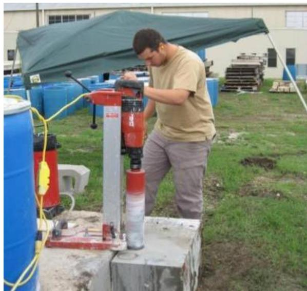
Figure 2.13 : Monitoring et échantillonnage des blocs de béton sur le site d'exposition extérieur de l'Université du Texas à Austin. A. Mesures d'expansion des blocs sur le site. B. Prélèvement d'échantillons dans les blocs pour réaliser les essais en laboratoire (expansion résiduelle, examen pétrographique par la méthode du DRI).
