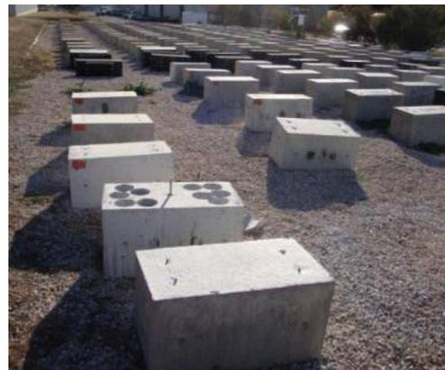
Figure 2.12 : Site d'exposition au laboratoire de la durabilité du béton de l'Université du Texas à Austin (Texas). A. Vue générale. B. Blocs de béton déposés sur le gravier compacté.
