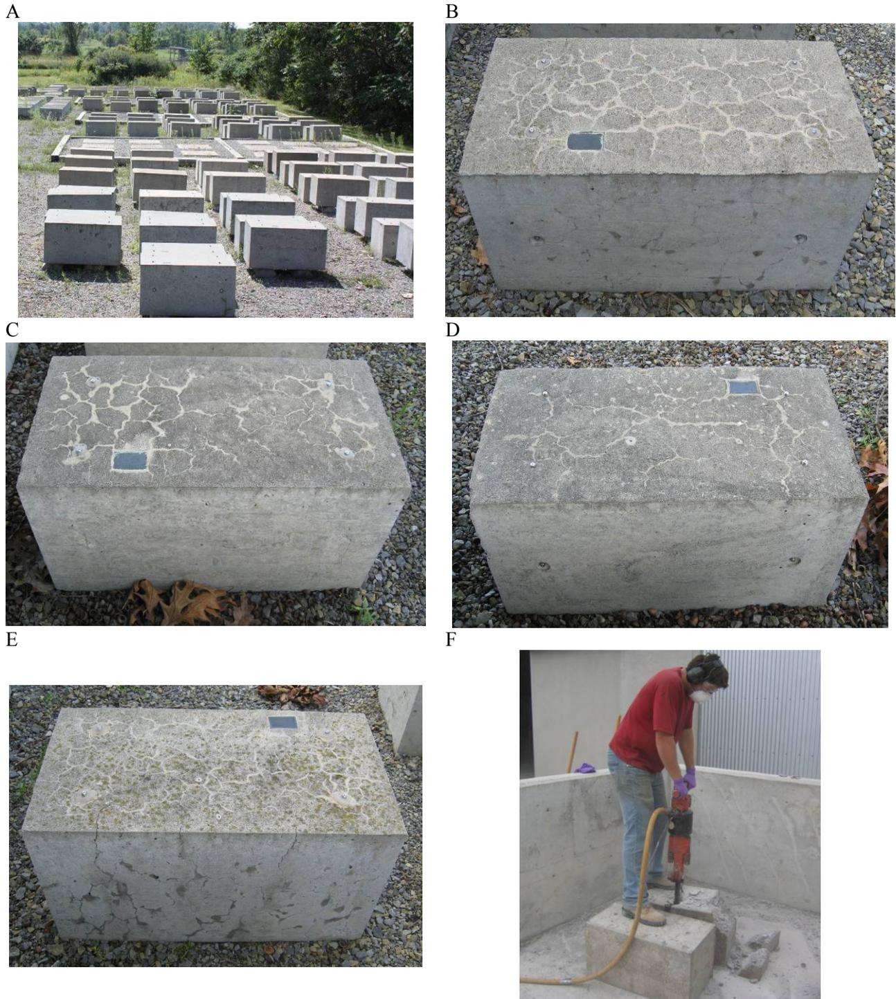
Figure 3.19 : Blocs de béton utilisés pour la fabrication des GBR (série des blocs de CANMET). A. Disposition des blocs sur le site de CANMET. B. Condition typique d'un bloc incorporant le granulats AG. C. Condition typique d'un bloc incorporant le granulats BL. D. Condition typique d'un bloc incorporant le granulats SL. E. Condition typique d'un bloc incorporant le granulats PS. F. Destruction des blocs pour la fabrication des GBR.
