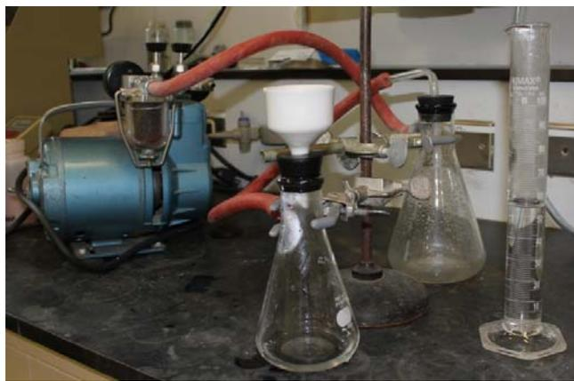
Figure F1 : A. Outil mécanique utilisé pour l'étape finale de préparation (pulvérisation) des échantillons pour l'essai de lixiviation à l'eau chaude. B. Montage utilisé pour la méthode *Espresso*, impliquant le filtrage sous vide de la solution.
