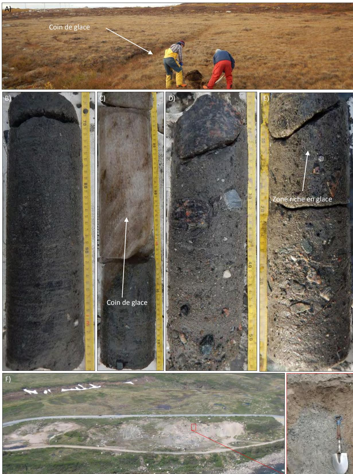
Figure 15: A) Sillon de coin de glace qui traverse le milieu environnant. B) Échantillon de sable fin avec traces de silt dont le contenu en glace semble moyennement élevé (TAS-2014-F6). C) Échantillon traversant un coin de glace (TAS-2014-F1). D) et E) Échantillons de sable et gravier assez grossier. F) Coupe stratigraphique à proximité de la route où un diamicton grisâtre a été observé.
