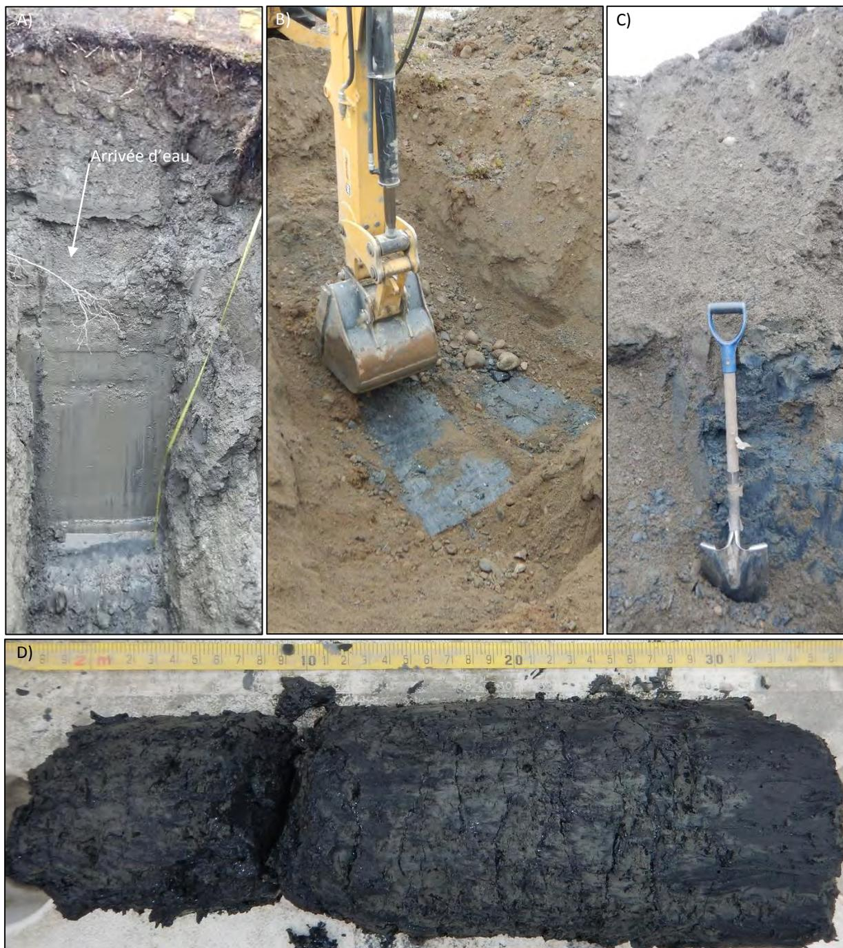
Figure 16: Argile silteuse grisâtre et compacte (Sédiments intertidaux : Mit) recouverte d'une couche de sable et gravier brunâtre (Alluvion) observée à l'excavation TAS-2014-T1 (A), au forage TAS-2014-F3 (B) et TAS-2014-F3a (C). Échantillon gelé d'argile silteuse grisâtre (USCS : CL) prélevé au forage TAS-2014-F3a.
