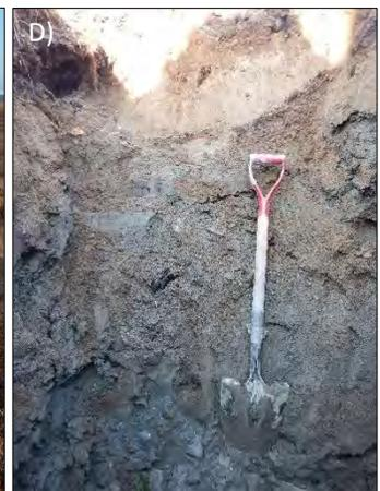
Figure 14: A) Environnement de surface et B) stratigraphie au site de l'excavation TAS-2014-T2 qui consiste en un sable grossier avec cailloux centimétriques arrondis où certaines sections du dépôt sont stratifiées. C) Secteur déprimé mal drainé entre les chaînages 0+900 et 1+000 m et D) excavation TAS-2014-T3 dans laquelle un diamicton a été rencontré près de la surface sous une mince couche de sable.
