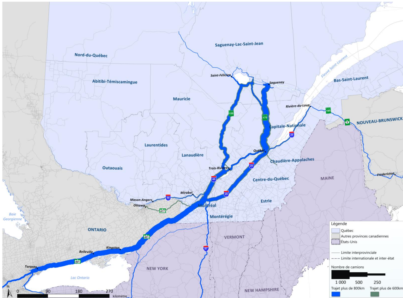
Figure 30-15 : Flux de camions interurbains participant au marché du territoire de PTMD du Saguenay–Lac-Saint-Jean, et parcourant plus de 600 km et plus de 800 km, semaine de 2006-2007
