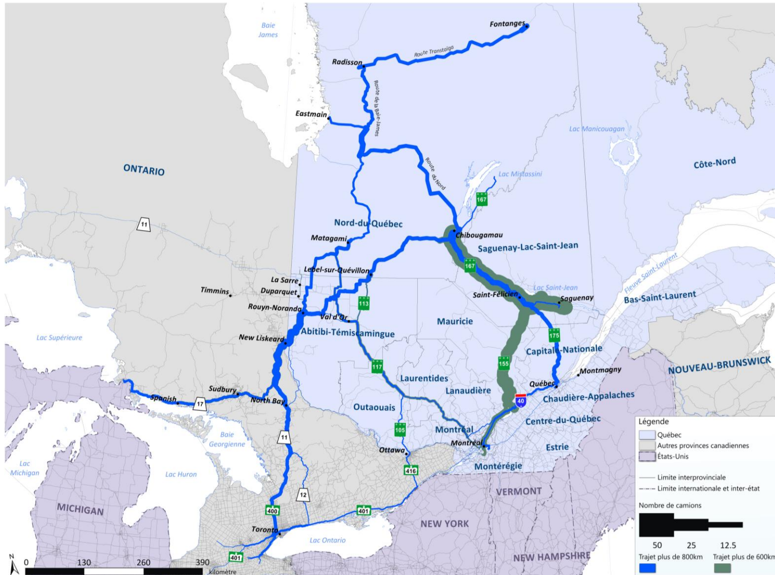
Figure 28-13 : Flux de camions interurbains participant au marché du territoire de PTMD du Nord-du-Québec et parcourant plus de 600 km et plus de 800 km, semaine de 2006-2007
