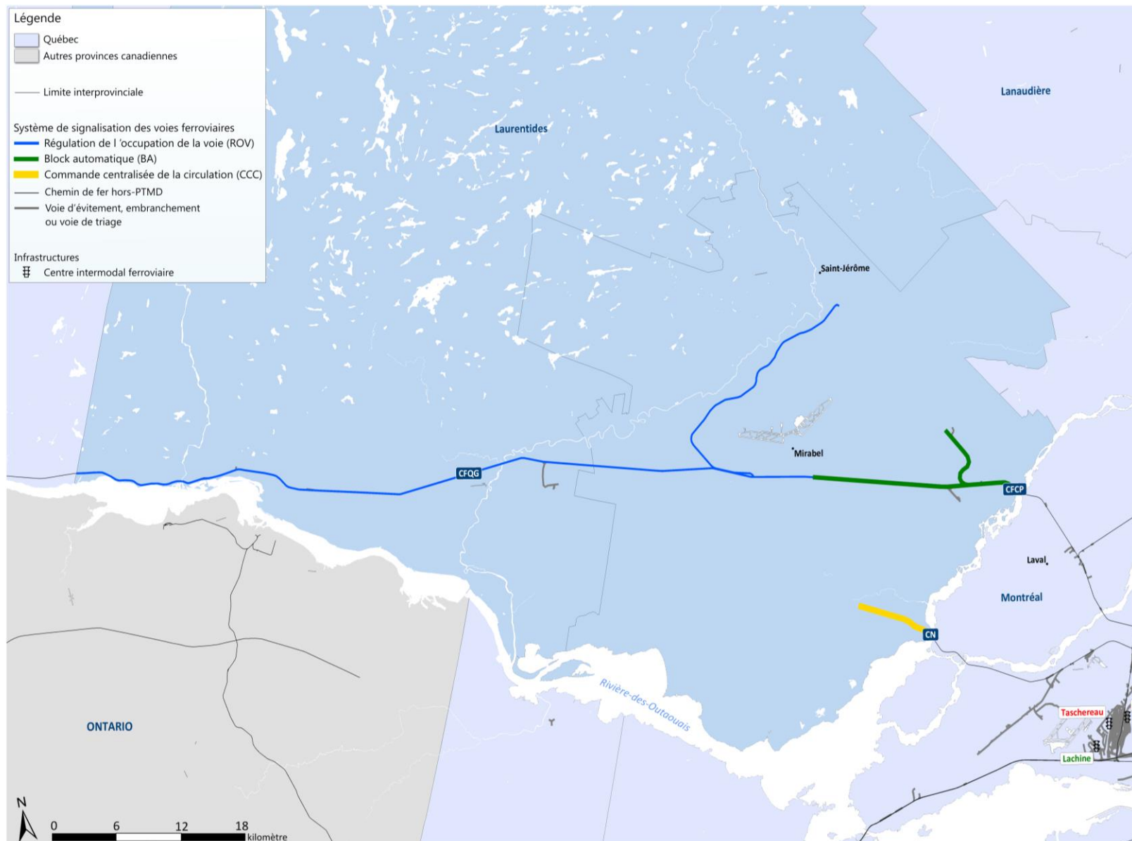
Figure 24-25 : Signalisation des lignes ferroviaires du territoire de PTMD des Laurentides, 2006
