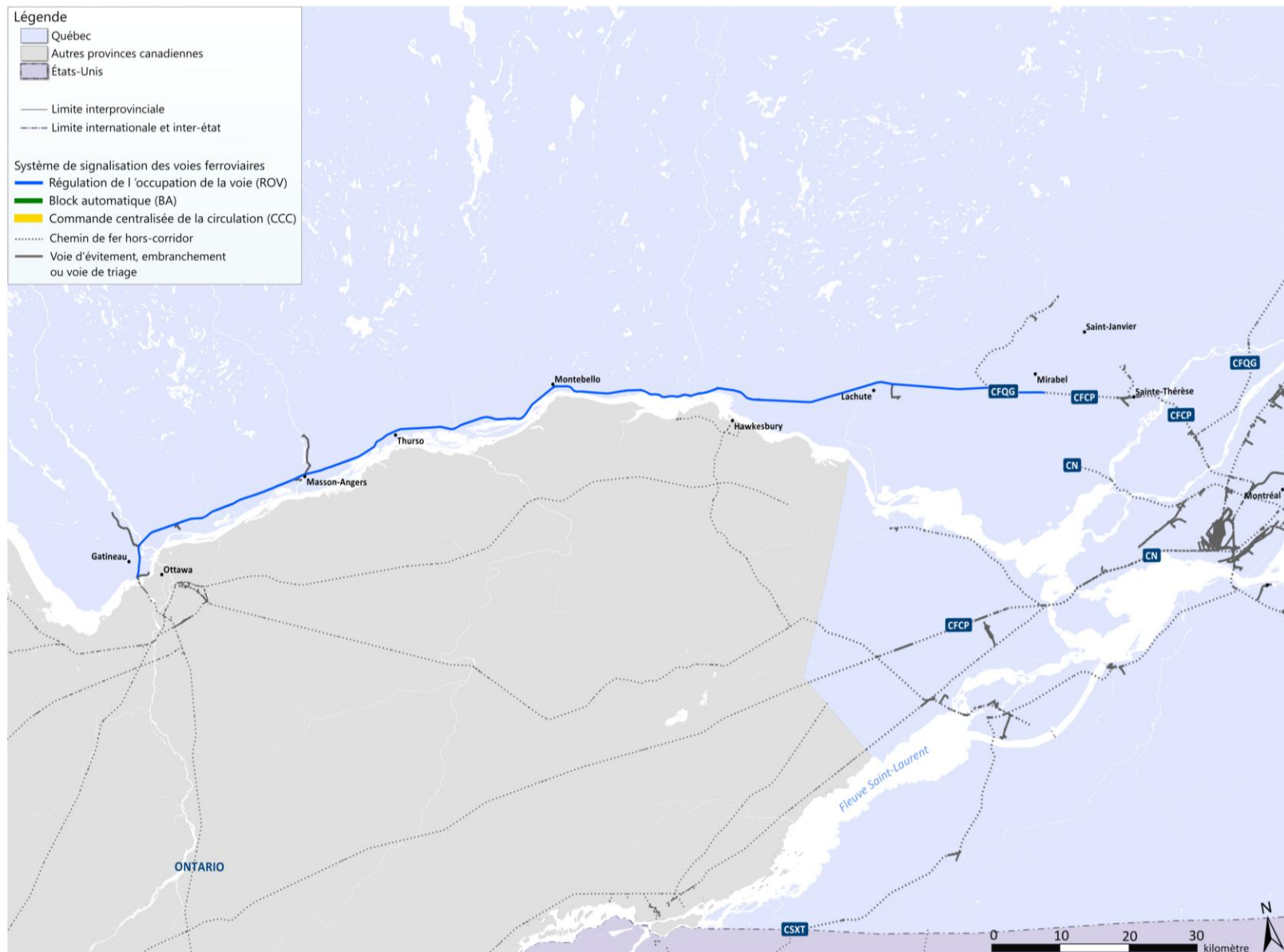
Figure 13-24 : Signalisation des lignes ferroviaires du Corridor J – Outaouais, 2010
