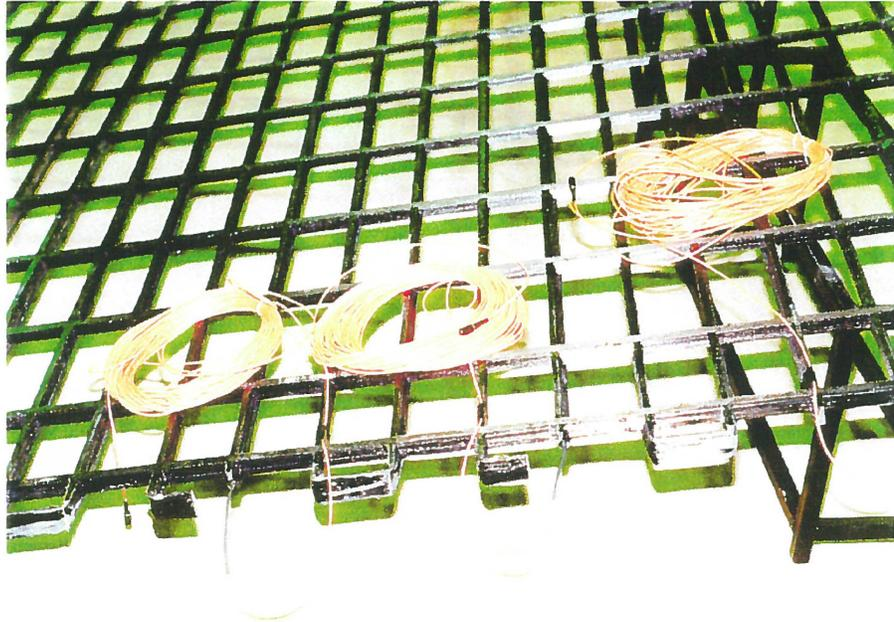
Figure 1. Vue rapprochée d'un treillis Nefmac instrumenté de capteurs à fibre optique
