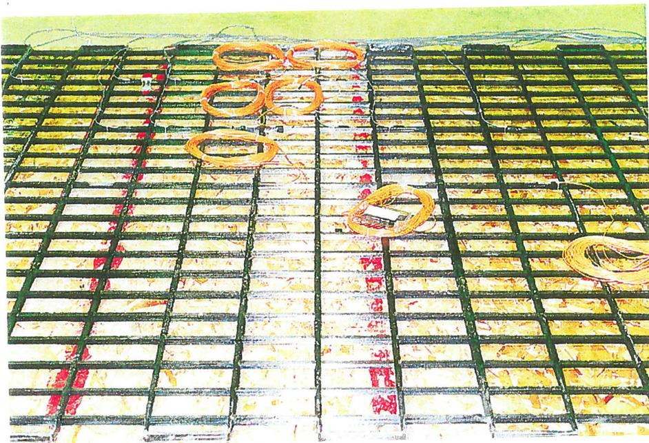
Figure 14. Vue générale de capteurs à fibre optique Fabry-Pérot de type SFO collés sur un treillis Nefmac
