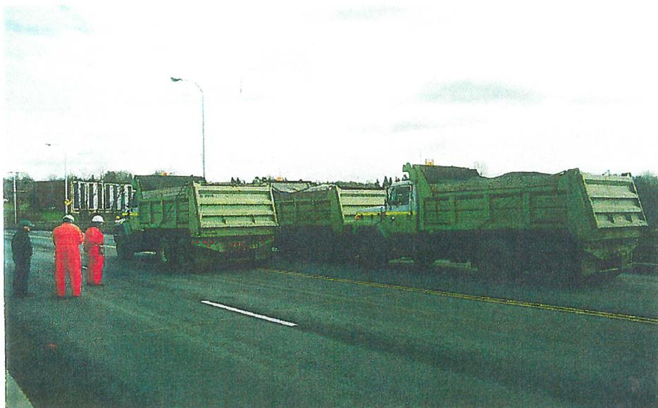
Figure 29. Camions positionnés sur le pont Joffre pour un essai de chargement statique
