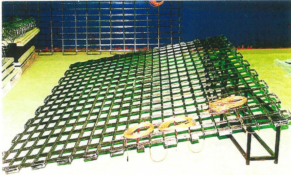
Figure 11. Vue globale des capteurs à fibre optique Fabry-Pérot de type SFO intégrés dans un treillis Nefmac (3.6 m × 2.4 m) pour la dalle du tablier du pont Joffre
