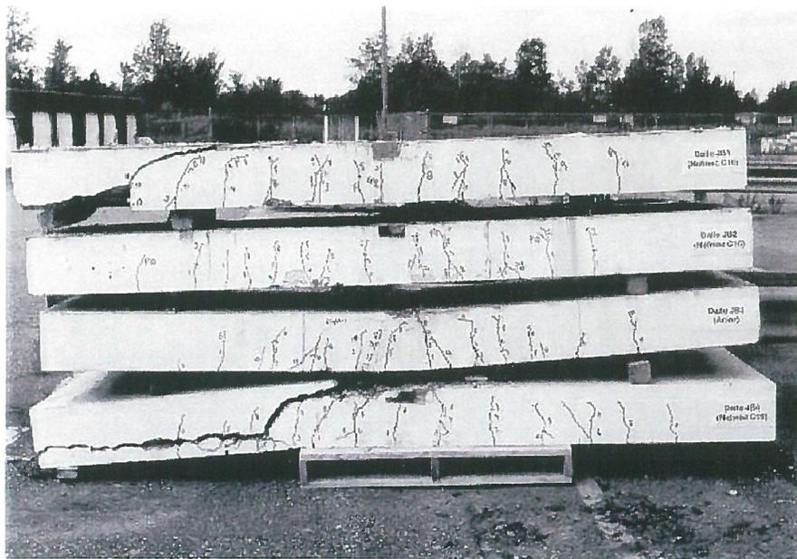
Figure 8. Modes de rupture et réseaux de fissuration des dalles
