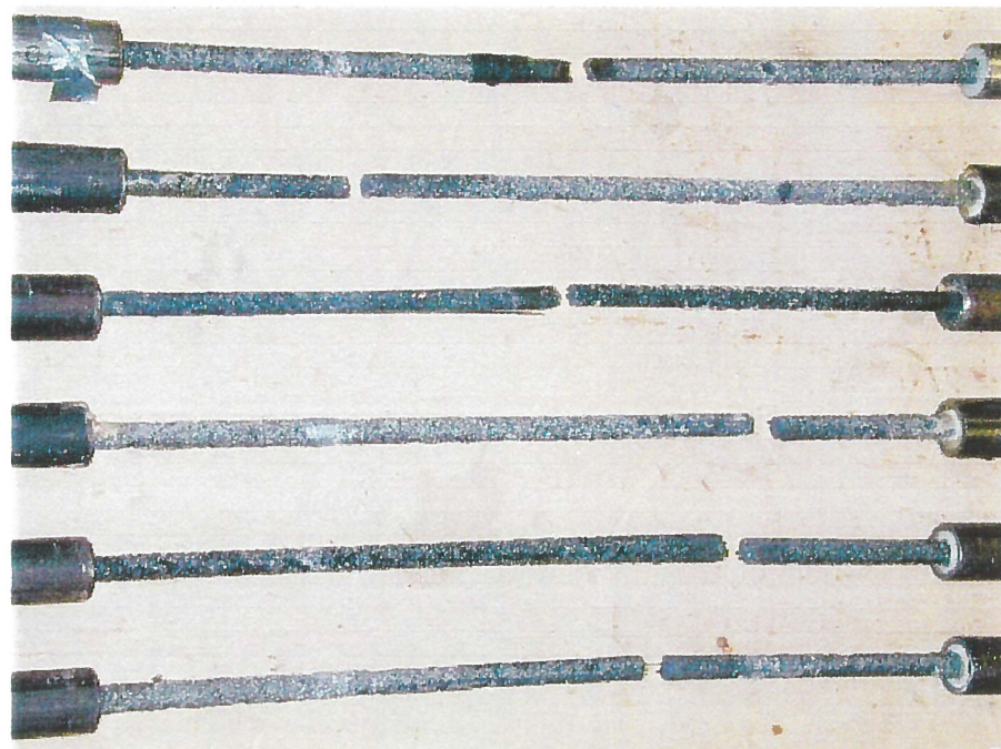
Figure 5 Modes de rupture en traction de l'armature
