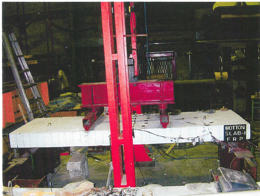
Figure 19 Vue du montage expérimental utilisé lors des essais de flexion des dalles
