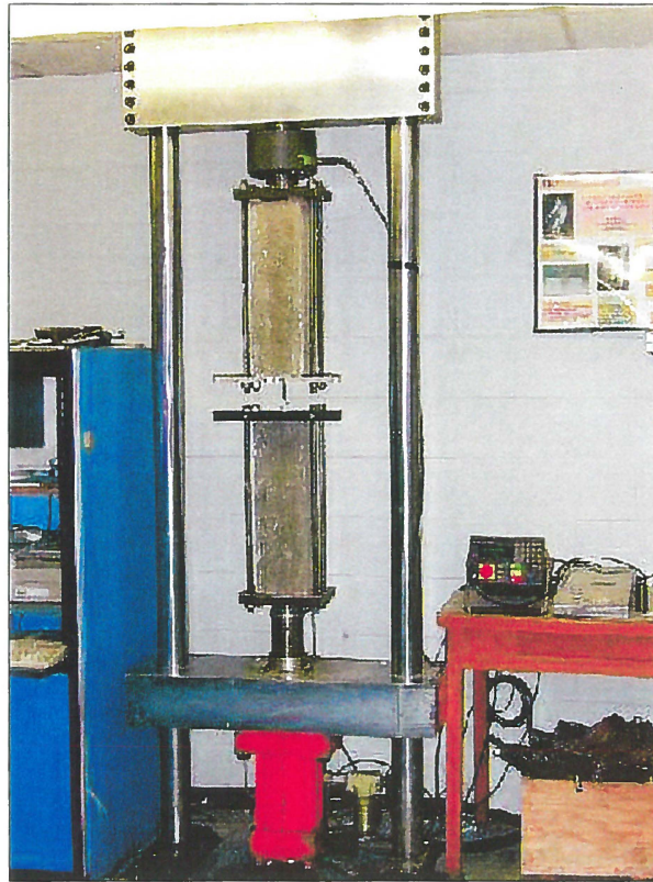
Figure 8 Vue du montage utilisé pour les essais d'arrachement
