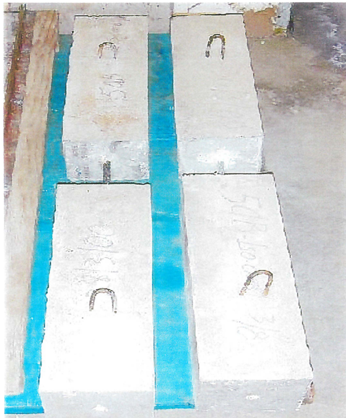
Figure 7 Vue montrant des échantillons pour les essais d'arrachement
