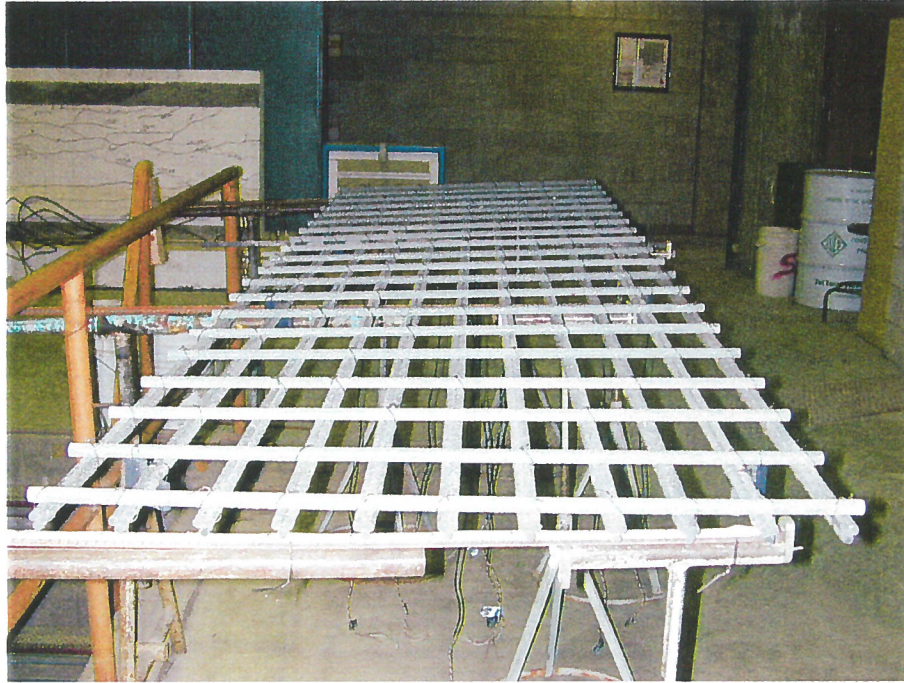
Figure 12 Vue d'un lit d'armature en matériaux composites utilisé dans les dalles
