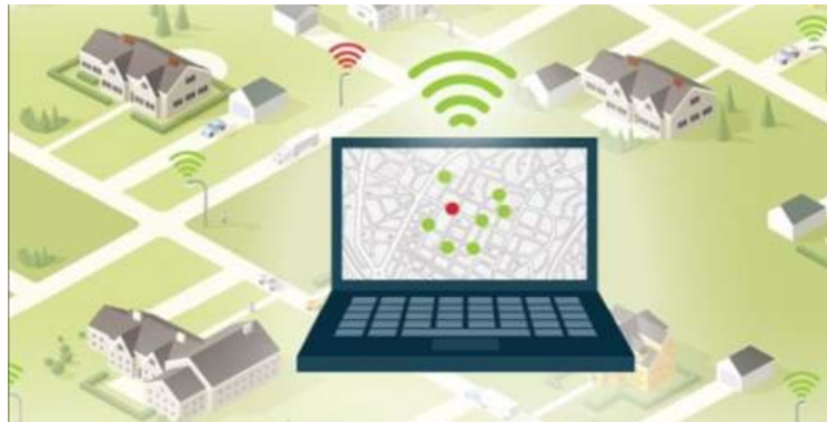
Figure 53: Géolocalisation des luminaires sur une application déportée permettant de faire de la gestion d'éclairage et d'envisager de l'allocation dynamique d'itinéraires (ici en cas de tornade). Source Ville de Chattanooga, LEDs2012 San Diego.
