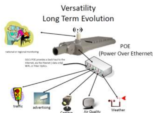
Figure 52: L'éclairage électronique travaille en coopération avec de nombreux senseurs et actuateurs. Source Ville de Chattanooga, LEDs2012 San Diego.
