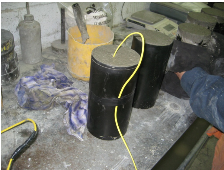
Photo 4 : Mise en place des thermocouples
