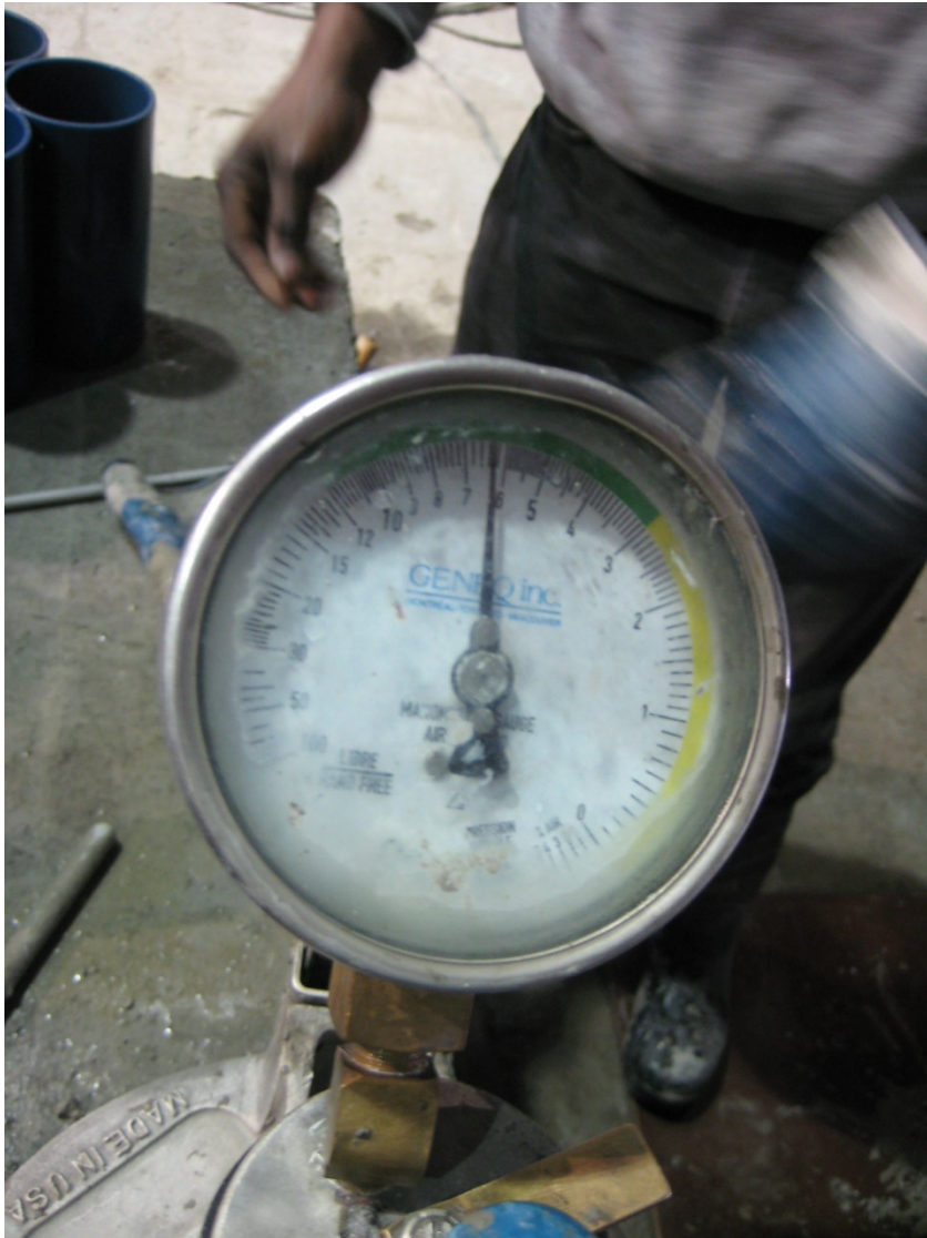
Photo 2 : Mesure des caractéristiques du béton : Teneur en air du mélange
