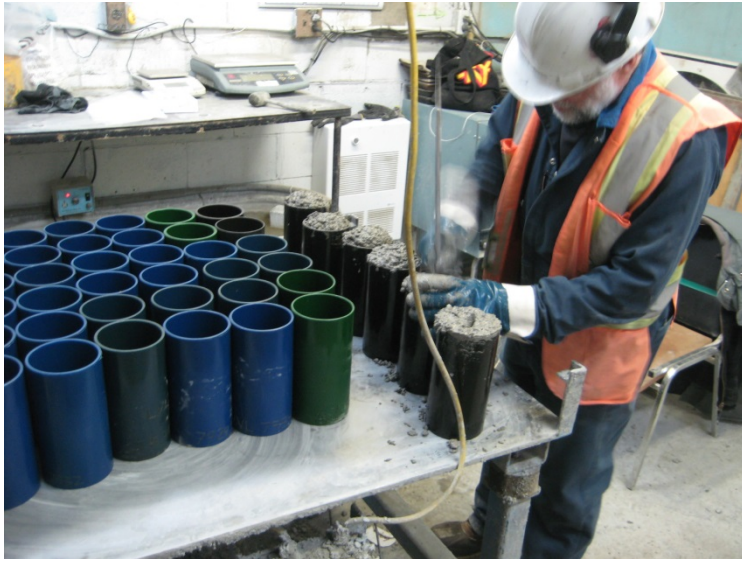
Photo 3 : Réalisation des cylindres selon les exigences de la norme CSA A23.2
