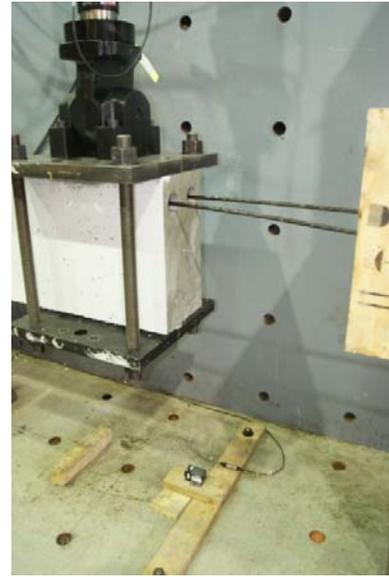
b) Corde de déplacement Nord attachée au centre de la section
