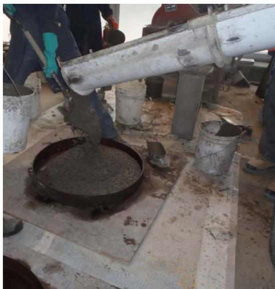
a) Chute du béton au centre du spécimen de dalle circulaire
