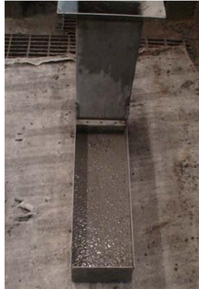
Figure 4.2 : Essai à la L-Box avant l'ajout des fibres
