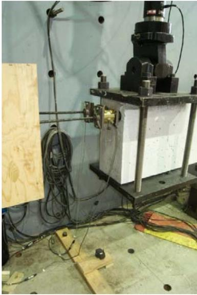
a) Corde de déplacement Sud attachée au centre de la section
