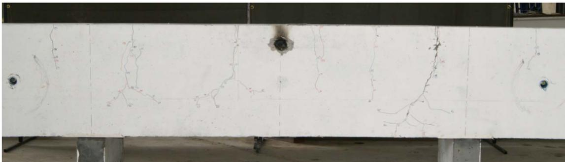
Figure 5.16 : BRF50-0.5-60 – Vue d'ensemble du relevé des fissures
