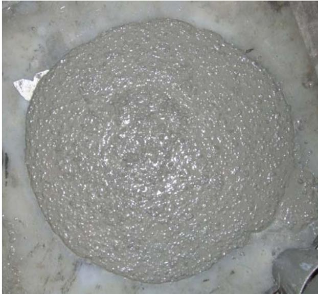
Figure 4.1 : Étalement au cône d'Abrams avant l'ajout des fibres
