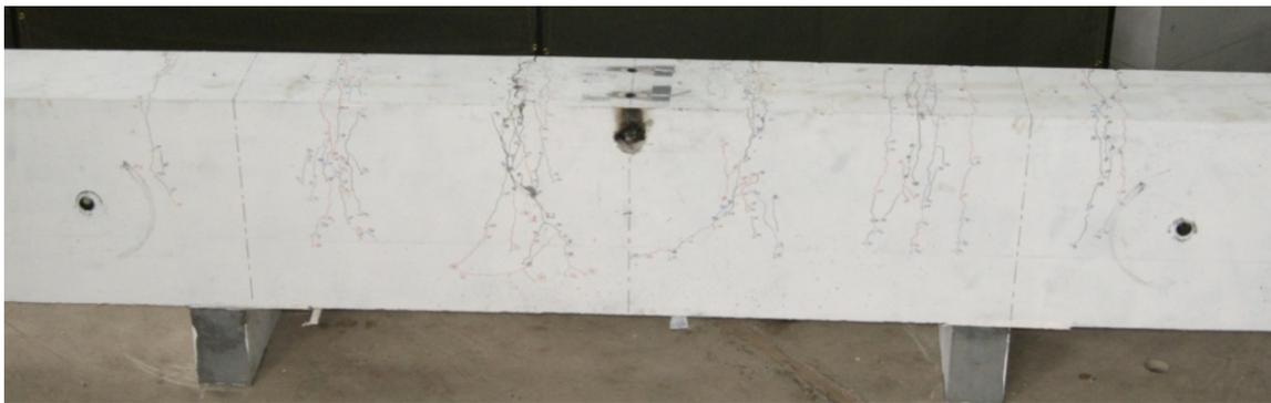
Figure 5.18 : BR50-0.75-60 – Vue d'ensemble du relevé des fissures
