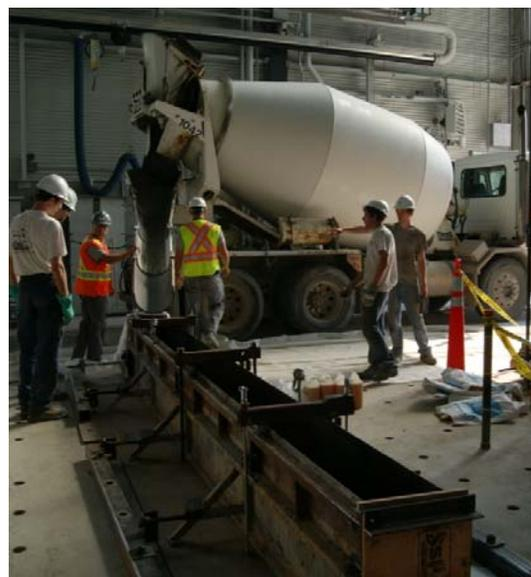
b) Coulée d'une poutre à partir de son extrémité Ouest avec des bétons autoplaçants
