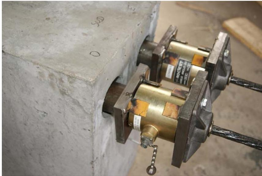
Figure 5.6 : Système de fixation des cellules de charge
