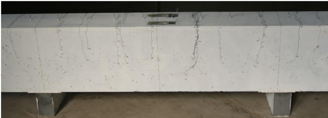
Figure 5.20 : BRF70-1.0-30 – Vue d'ensemble du relevé des fissures
