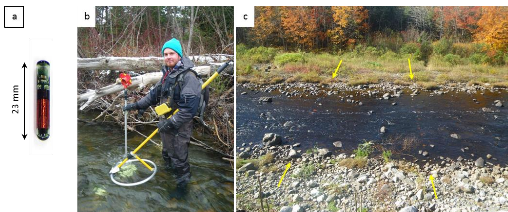
Figure 18. Systèmes pour le suivi de la mobilité de la couche active du lit. a – Aperçu d'un transpondeur passif; b – système pour la détection (antenne) et le positionnement (station totale) des particules de graviers implémentées de transpondeurs passifs et; c – positionnement des particules par sections transversales de part en part du cours d'eau.
