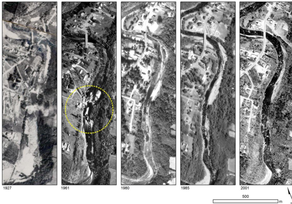
Figure 79. Historique des changements géomorphologiques dans la zone des barrages démantelés du village de Saint-Pacôme. En jaune : identification des sédiments stockés par les barrages.
