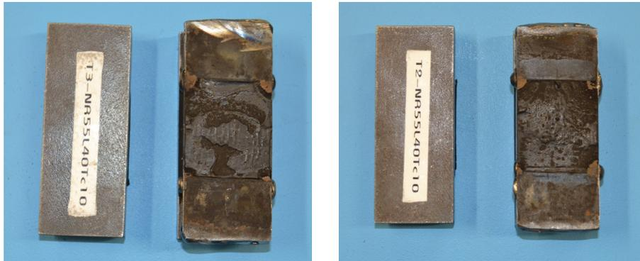
Figure 4.32 – Faciès de rupture par cavitation des spécimens de la série T
