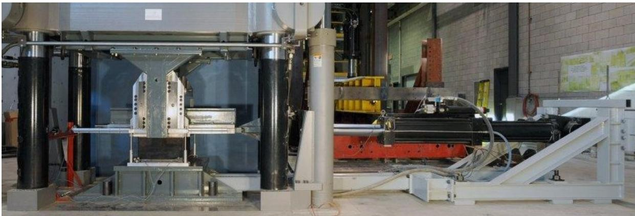
Figure 4.2 – Montage expérimental pour les isolateurs de taille réelle
