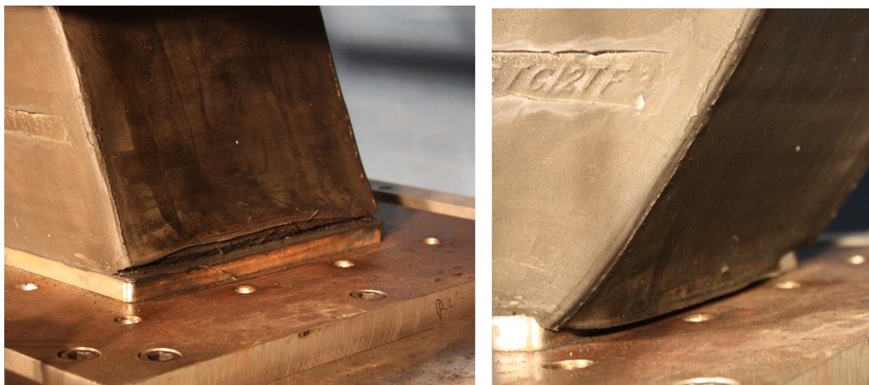
Figure 4.7 – Décollement à la base des spécimens sans recouvrement autour des plaques d’ancrage (illustration pour B1)
