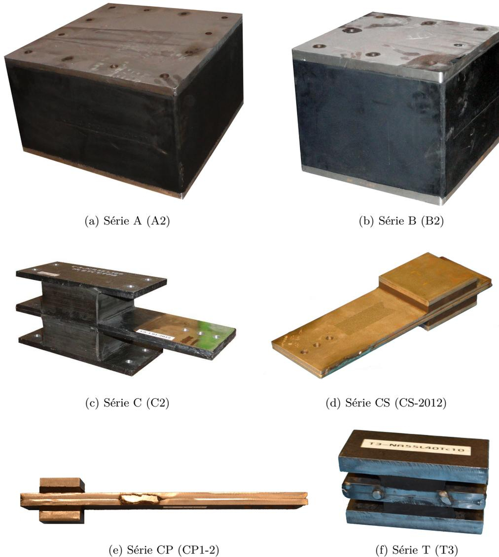
Figure 4.5 – Architecture des différentes séries de spécimens expérimentaux
