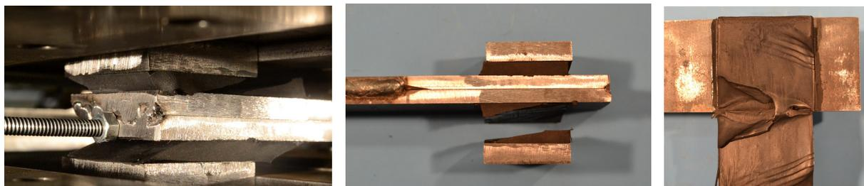
Figure 4.31 – Photos des spécimens CP après rupture par déchirement
