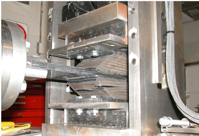
Figure 4.29 – Photo du spécimen C3-2 au moment de la rupture par déchirement
