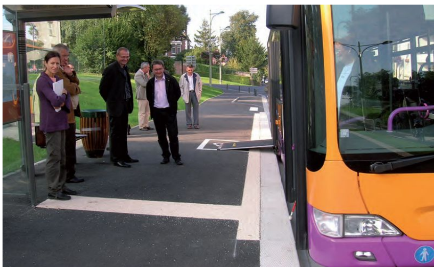
Photo d'un aménagement d'un arrêt en milieu urbain avec présence de deux bandes contrastées, l'une pour signaler le danger, l'autre pour signaler la porte avant, ainsi que d'une signalisation de la porte centrale par un carré blanc et un logo « UFR » avec aire de rotation d'1,50 m en plus de la rampe déployée (Source : SDA du syndicat mixte Artois-Gohelle, juin 2009).
