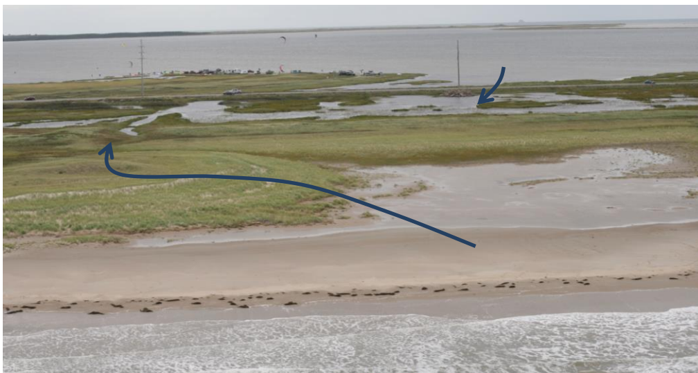
Figure 117. Submersion par la lagune et par une brèche dans les dunes – distance importante, pas de déferlement
