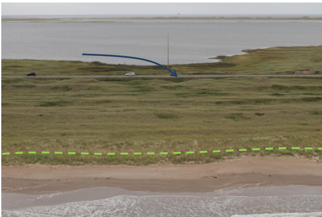
Figure 118. Submersion par la lagune – dunes du côté de la baie empêchant la submersion
