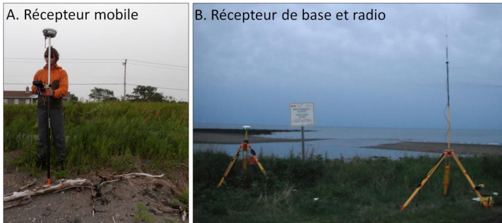
Figure 23. Récepteur Trimble R8
