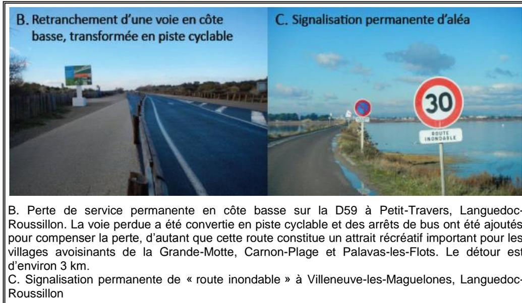
**Stratégie 29. Acceptation d'une baisse permanente de service.** À l'instar des exemples français, retrancher une voie (transformation en sens unique), utiliser des mesures de diversification des accès (intermodalité) et des signalisations permanentes d'aléas pour s'adapter à une baisse permanente de service.
