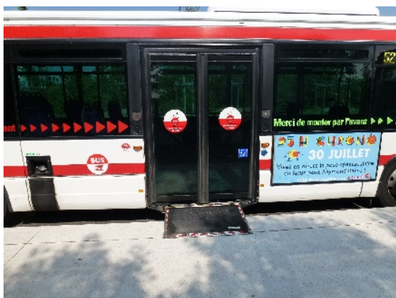
Rampe amovible dépliée sur le quai
