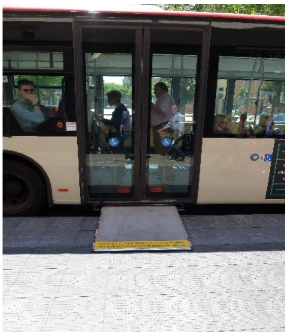
Déploiement de la rampe d'accès
