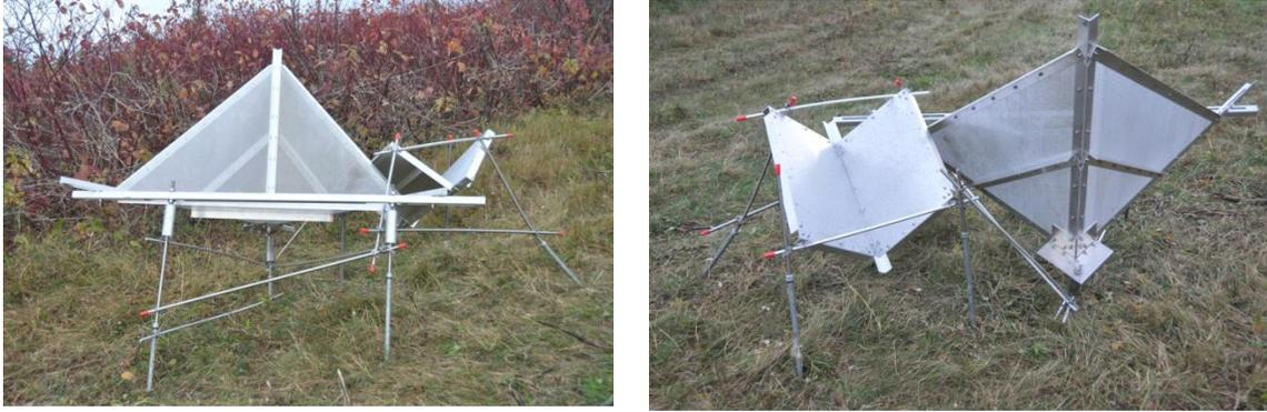
**Figure 3** Exemple de couple de réflecteurs disposés selon la configuration Ascendant-Descendant.
