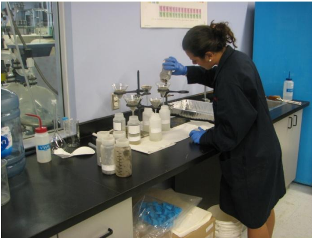
Filtration du lixiviat. Labo STEPPE ÉTS 27.07.2012
