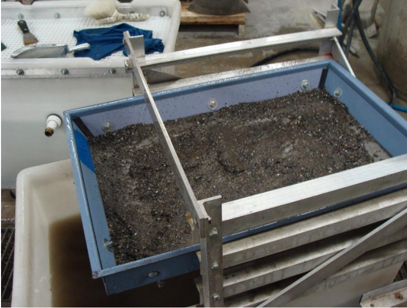
Résidus de lavage et tamisage passant de 5 mm et refus de 160 µm. Labo Matériaux ÉTS 15.06.12
