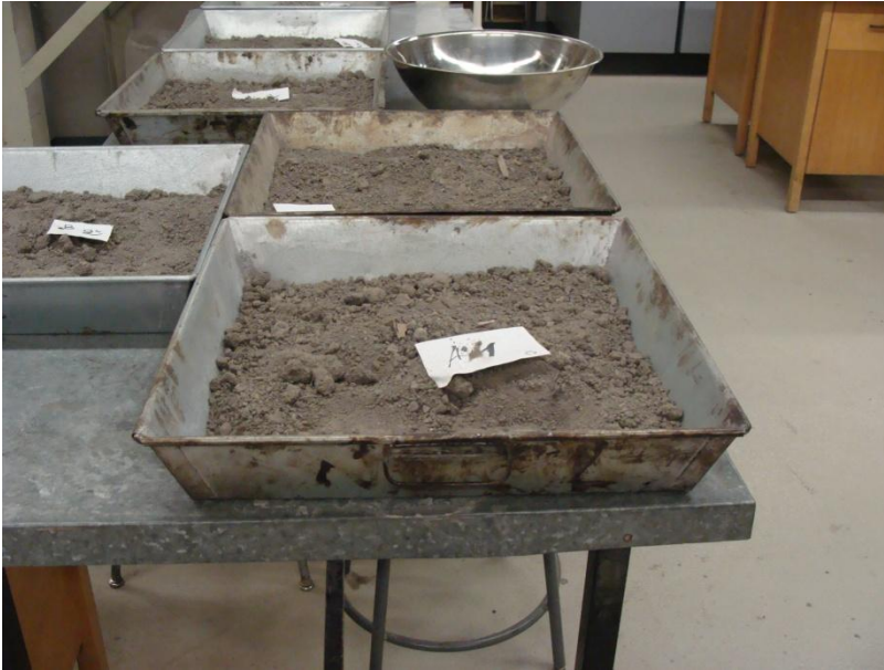
Échantillons étuvés à 110°C. Labo Matériaux ÉTS
