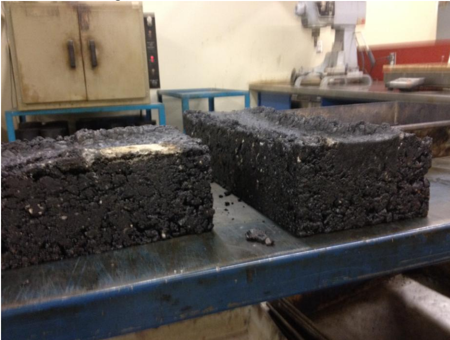
Éprouvettes à l'issue de l'essai à l'orniéreur, Labo enrobés ÉTS 18.01.2014
