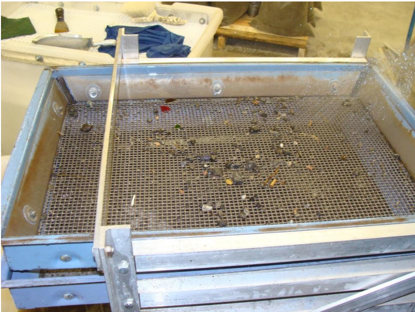
Résidus de lavage et tamisage refus de 5 mm. Labo Matériaux ÉTS 15.06.12
