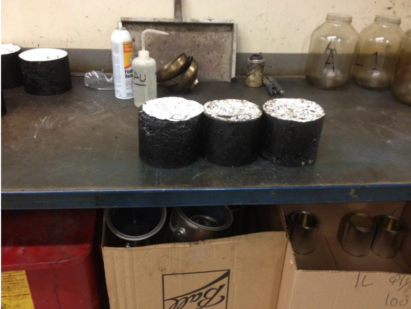
Éprouvettes de GB-20 compactées à la PCG, Labo enrobés ÉTS 14.11.2013
