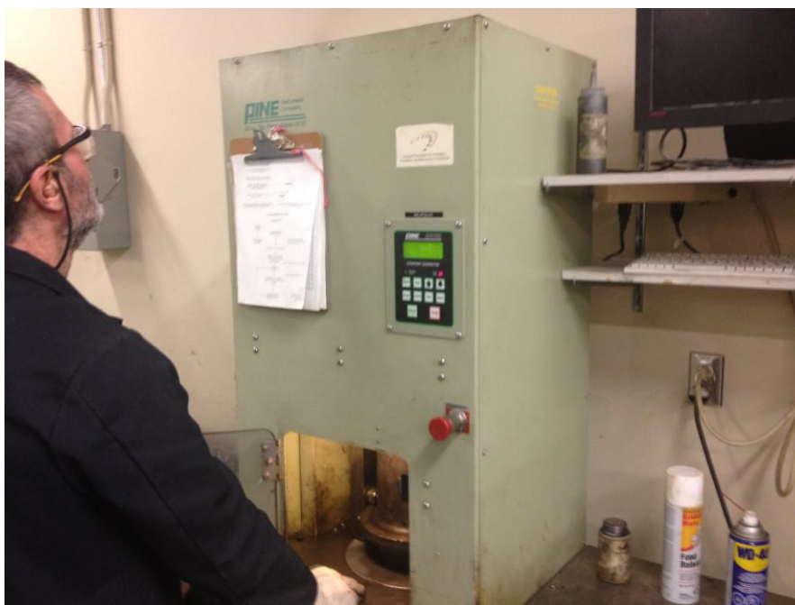
Figure 7.1 Introduction du cylindre de moulage de GB-20 dans la PCG, ETS
