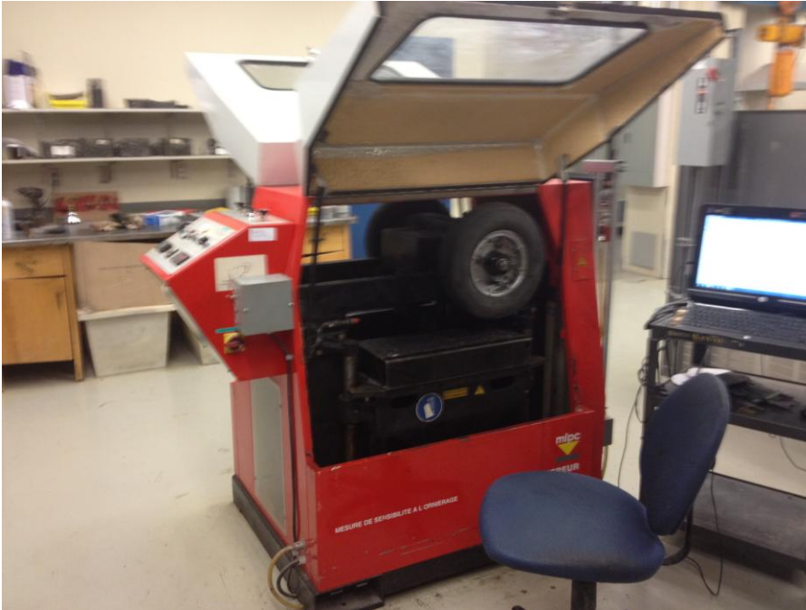
Essai de l'orniérage, Labo enrobés ÉTS 17.01.2014
