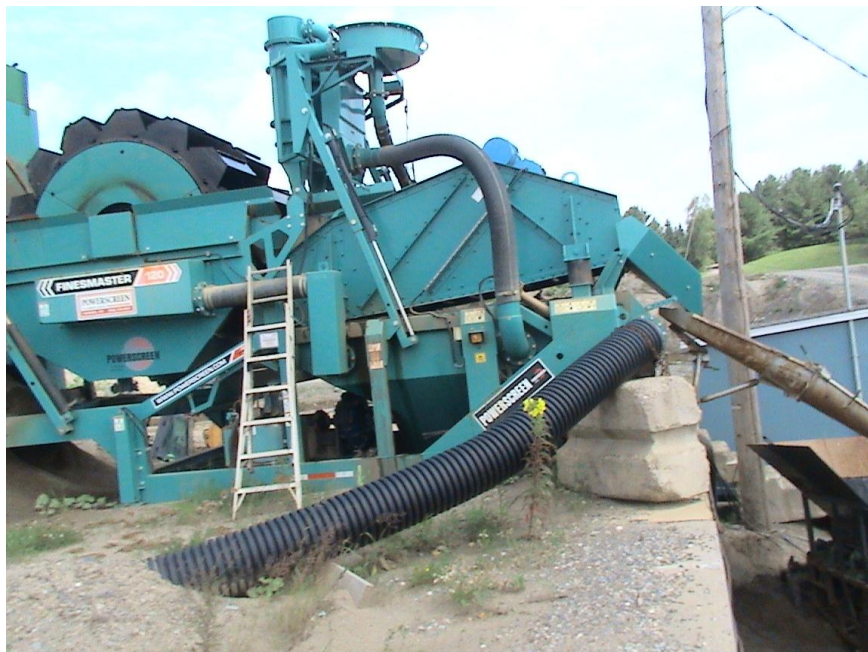
Figure 6.3 Lavage et tamisage des abrasifs Bromont le 05.07.2013
