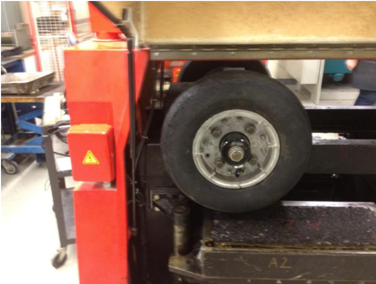
Essai de l'orniérage, Labo enrobés ÉTS 17.01.2014
