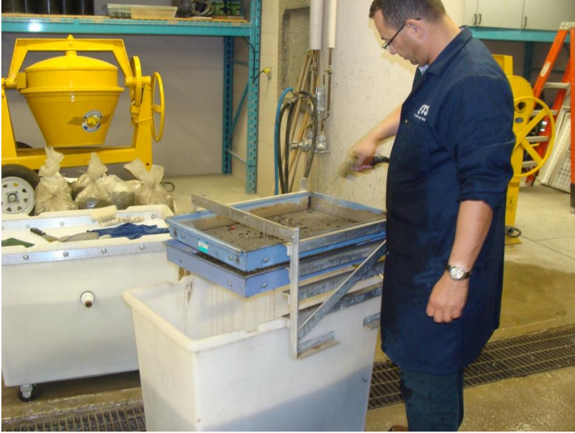
Lavage- tamisage 160 \mu\text{m} – 5 mm. Labo Matériaux ÉTS 15.06.12
