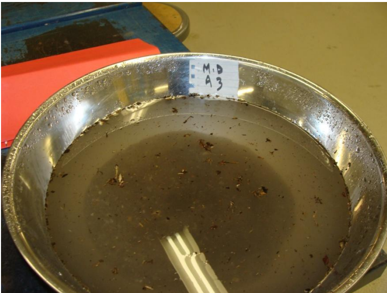
Lavage par décantation – préparation micro-deval. Labo Matériaux ÉTS
