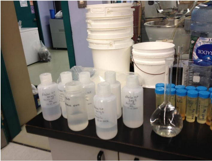
Solutions étalons pour l'ICP. Labo STEPPE ÉTS 20.09.2012
