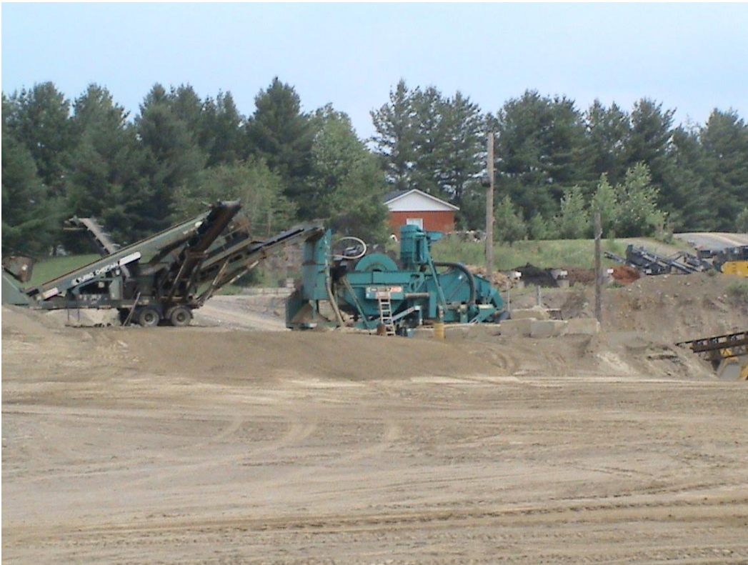
Opération de tamisage et lavage à l'hydrocycloneur, Bromont 05.07.2013
