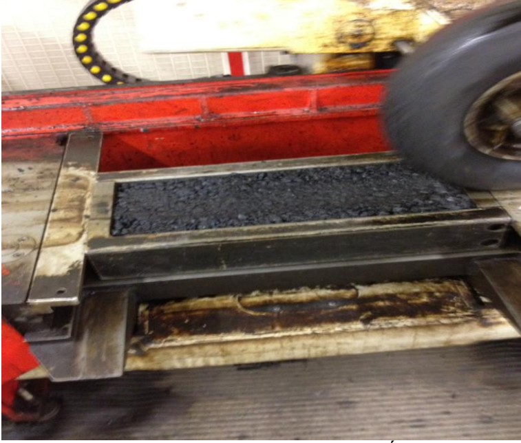
Compactage de l'éprouvette, Labo enrobés ÉTS 15.01.2014
