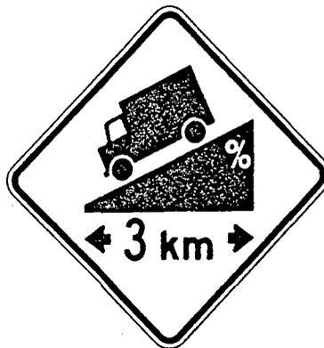
DOIT ÊTRE UTILISÉ LORSQUE LA LONGUEUR DE LA PENTE EST SUPÉRIEURE À 1 KILOMÈTRE.
