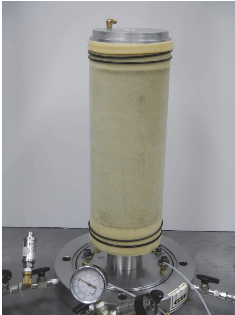
Figure 22 Membrane étanche sur l'éprouvette de matériau granulaire
