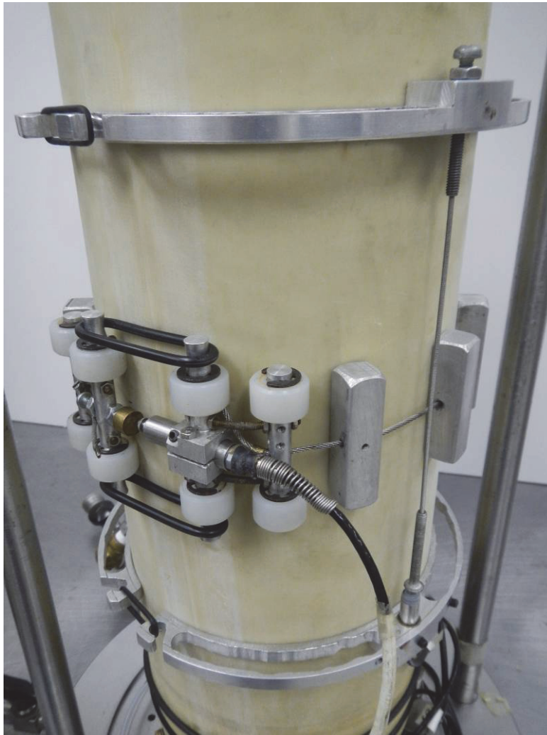
Figure 26 Capteurs de déplacement axiaux et radial installés sur l'éprouvette
