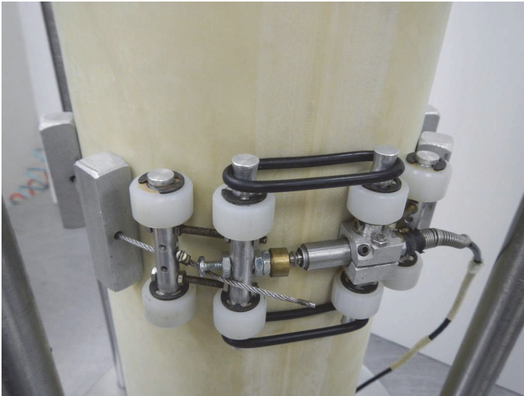
Figure 24 Capteur de déplacement radial installé sur l'éprouvette
