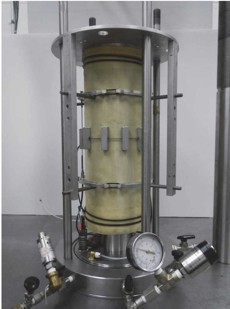
Figure 25 Installation des capteurs de déplacement axiaux
