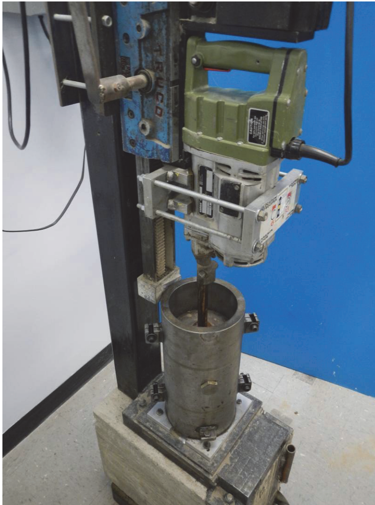
Figure 19 Marteau vibrant lors du compactage d'une couche de matériau granulaire à l'intérieur du moule
