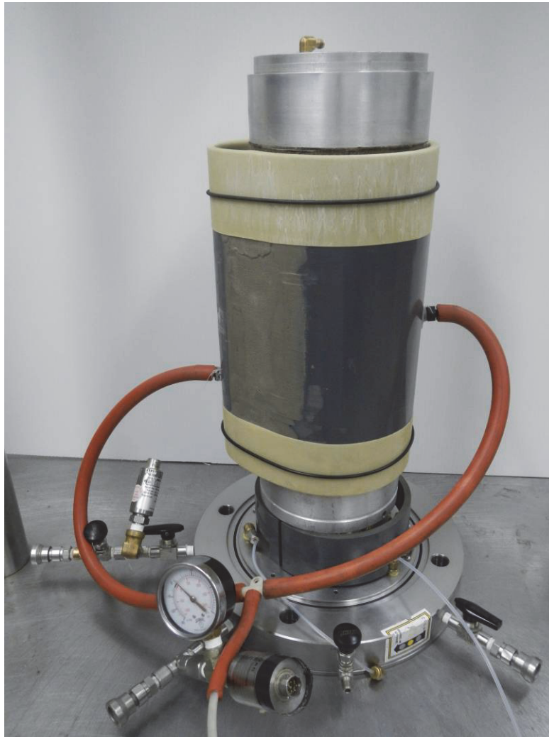
Figure 21 Installation de la membrane sur l'éprouvette à l'aide d'un tendeur de membrane
