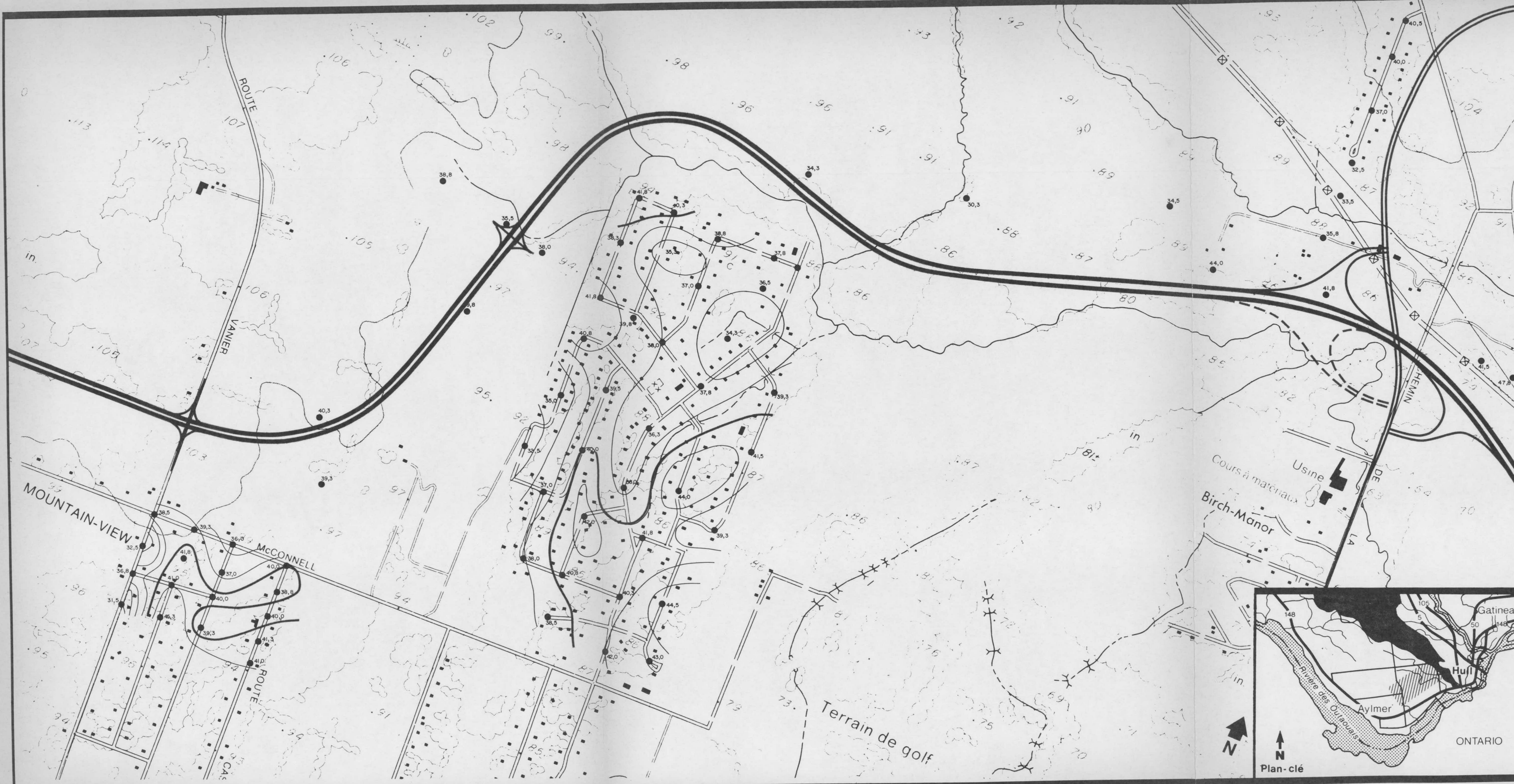
ISOCONTOURS DES NIVEAUX DE BRUIT DE FOND (L 99%) (période diurne normale) Secteur chemin de la Montagne au chemin Vanier
