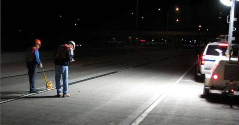
Figure 3-3 : Relevé de la propagation des fissures sur la surface de la chaussée en BAC
