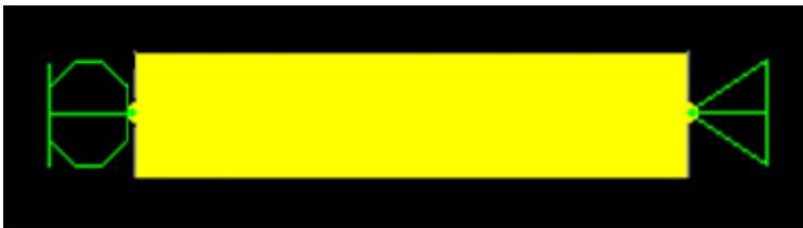
Figure 4-4 : Schéma de la dalle: (a) Totalement retenue; (b) partiellement retenue
