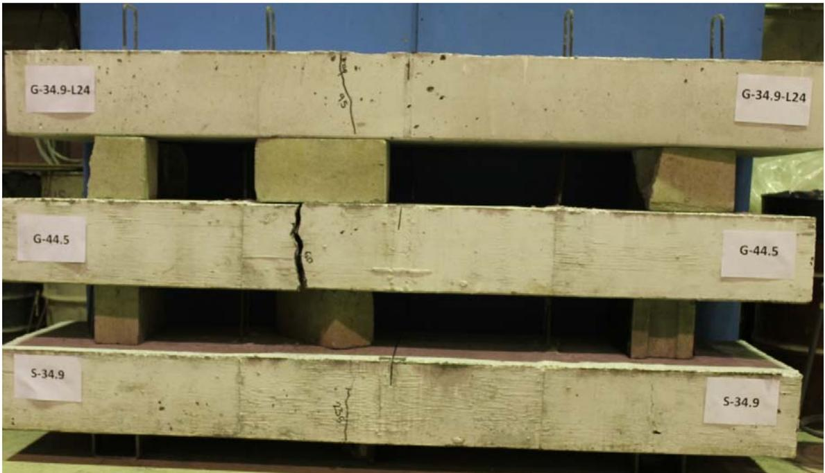
Figure 2.20 (Suite): Réseau des fissures des spécimens testés
