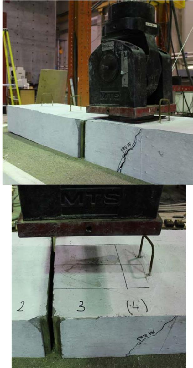
Figure 2.11: Réseau des fissures du spécimen G-31.8-CY
