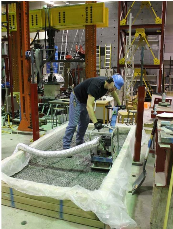
Figure 2.18: Préparation de la base granulaire dans le laboratoire de structure
