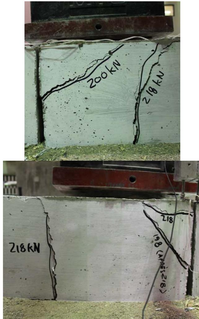
Figure 2.12: Réseau des fissures du spécimen G-34.9-CY
