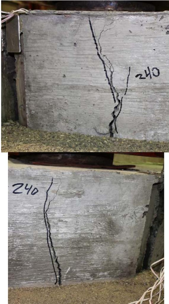
Figure 2.8: Réseau des fissures du spécimen G-31.8-2
