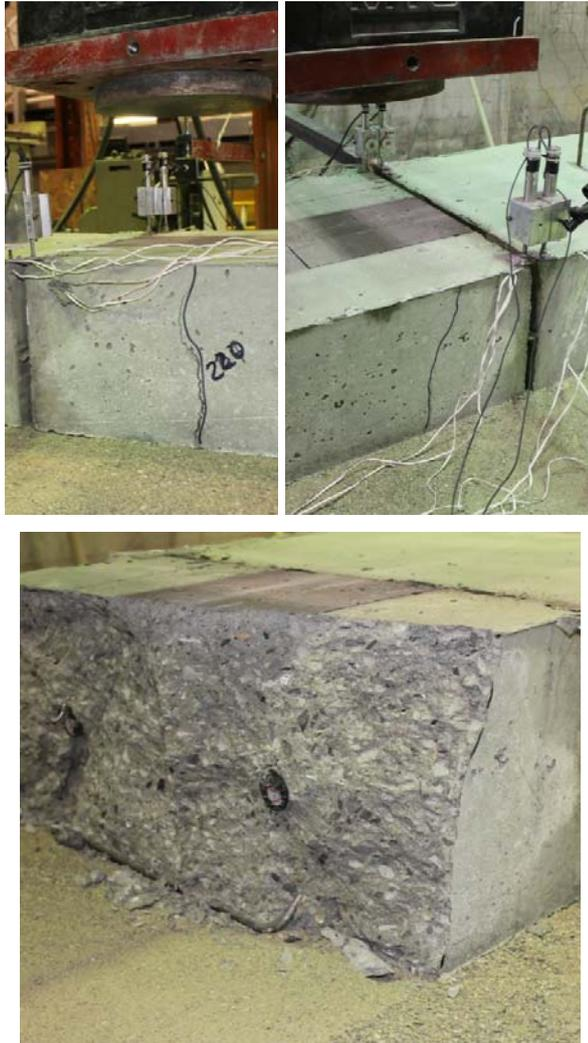
Figure 2.9: Réseau des fissures du spécimen G-34.9-2
