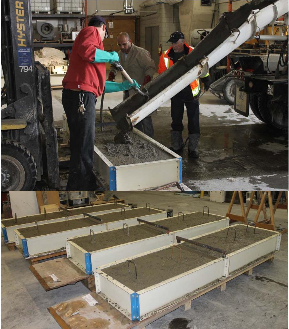
Figure 2.15: Coulage du béton pour la fabrication des spécimens d'essais de la Phase II
