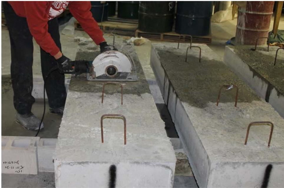
Figure 2.16: Sciage des dalles d'essai au tiers de la profondeur (ouverture 3,5 mm)
