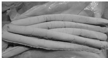
Figure 6- Gains de textile perméable contenant l’adhésif cimentaire
