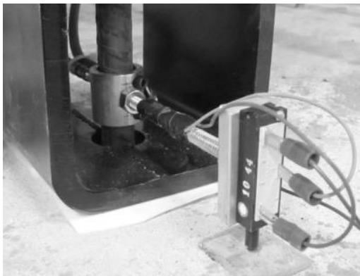
Figure 10- Aperçu des différents équipements et capteurs utilisés pour les essais de chargement soutenu (déplacement de fluage)
