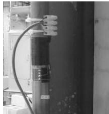
Figure 10- Aperçu des différents équipements et capteurs utilisés pour les essais de chargement soutenu (déplacement de fluage)
