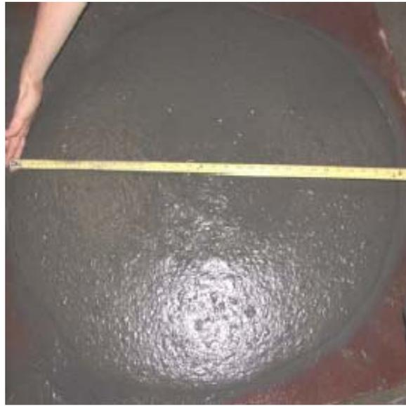
Figure 4.8 – Test d'étalement d'un BFUP contenant 3% de fibres développé à l'ÉPM [14]
