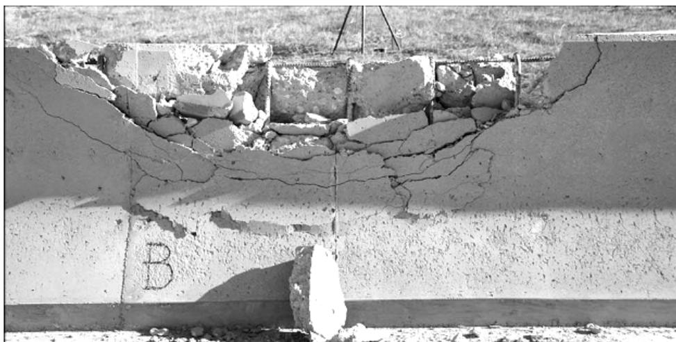
**Figure 3 - Mode de rupture pour les parapets coulés en place (Williams, Butch, & Menges, 2007)**
