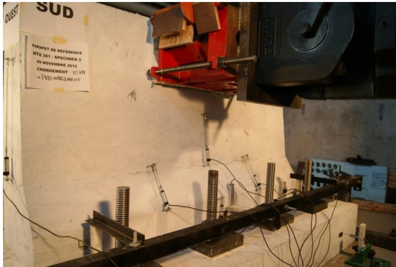
**Figure 23 - Montage avec les principaux capteurs sur le parapet**
