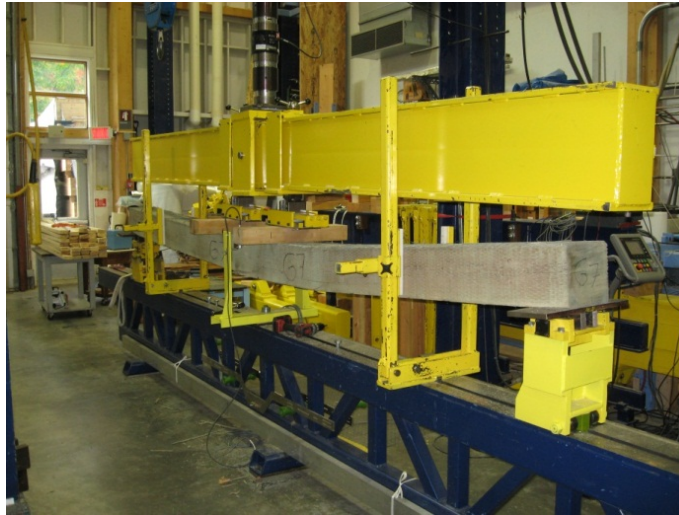
Figure 4 Dispositif d'essais de flexion
