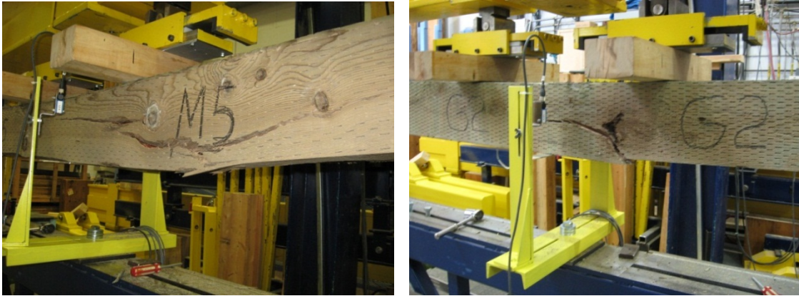
Figure 7 Modes de rupture - Essais de flexion
