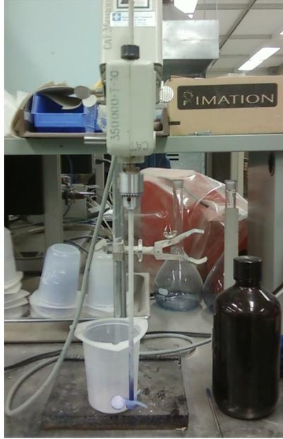
**Figure 3.14 - Montage de l'essai de la valeur au bleu de méthylène**
