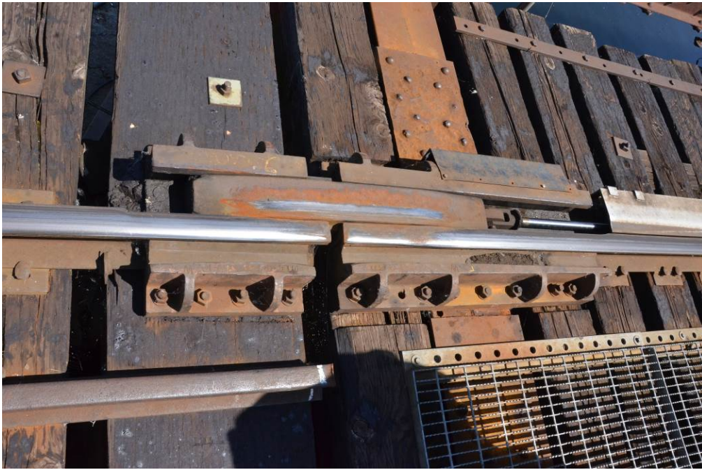
Figure 48 - «Coin» de rail utilisé
