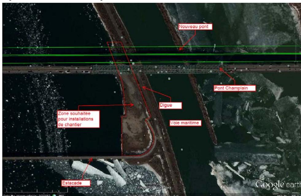
Figure 5 Installation de chantier – Rive-Sud
