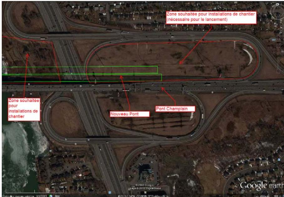
Figure 6 Installation de chantier – Montréal et Île-des-Sœurs
