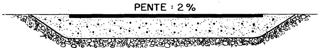
Si la piste est implantée au pied d'une dénivellation importante ou à flanc de coteau, une rigole est nécessaire, le long du côté supérieur de la piste, pour capter l'eau de ruissellement lors de pluies abondantes. Cet aménagement est particulièrement opportun dans le cas des pistes recouvertes de poussière de roche puisque sans cette rigole collectrice, la piste est susceptible d'être endommagée à chaque pluie.
