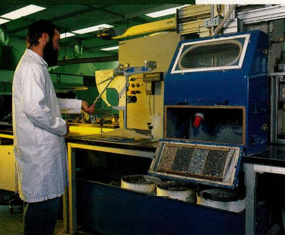
L'appareil de polissage par projection (CPP-LPC) et le pendule SRT servent à évaluer la résistance au polissage des granulats. Le résultat obtenu, le coefficient de polissage par projection (CPP), est en relation avec les relevés d'adhérence effectués sur la route à l'aide de l'appareil SCRIM.
