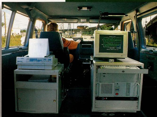
*Le profilomètre inertiel permet d'effectuer des mesures de précision servant à l'évaluation du profil et l'application des clauses d'uni.*
