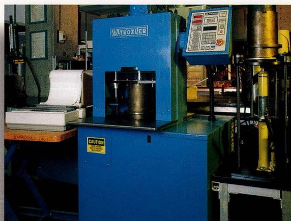
La presse à cisaillement giratoire de type SHRP est un outil de formulation des enrobés permettant d'en déterminer la maniabilité.
