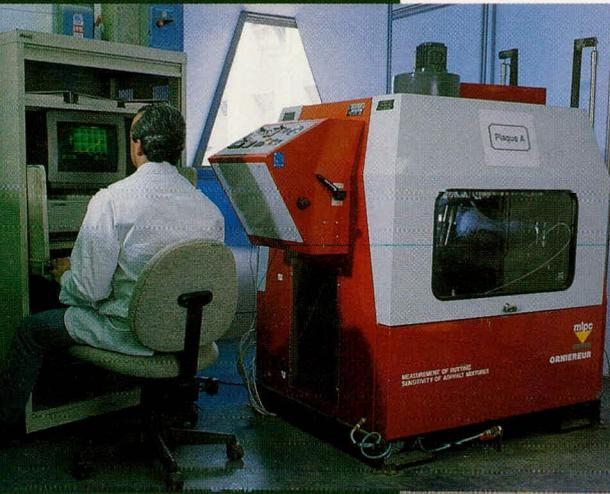
L'orniéreur de laboratoire LPC automatisé MTQ permet de tester le comportement des enrobés au regard des déformations plastiques de type orniérage-fluage dans des conditions comparables aux sollicitations sur chaussées.
