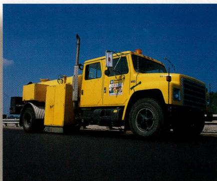
*Le SCRIM mesure la qualité du contact pneus-chaussée sur surface mouillée; il indique ainsi le niveau d'adhérence. Une bonne adhérence pneus-chaussée limite les risques d'aquaplanage et de dérapage.*
