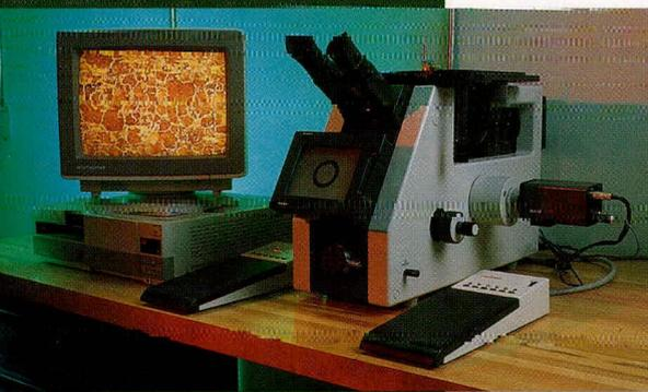
*Le métallographe est un équipement d'optique vidéo servant à l'examen de la structure interne des métaux. Son utilisation est indispensable à la réalisation d'expertises servant à caractériser le matériau et à expliquer sa performance. Il permet la visualisation des phases intermétalliques des revêtements anti-corrosion. (Photo : Jacques Lessard)*
