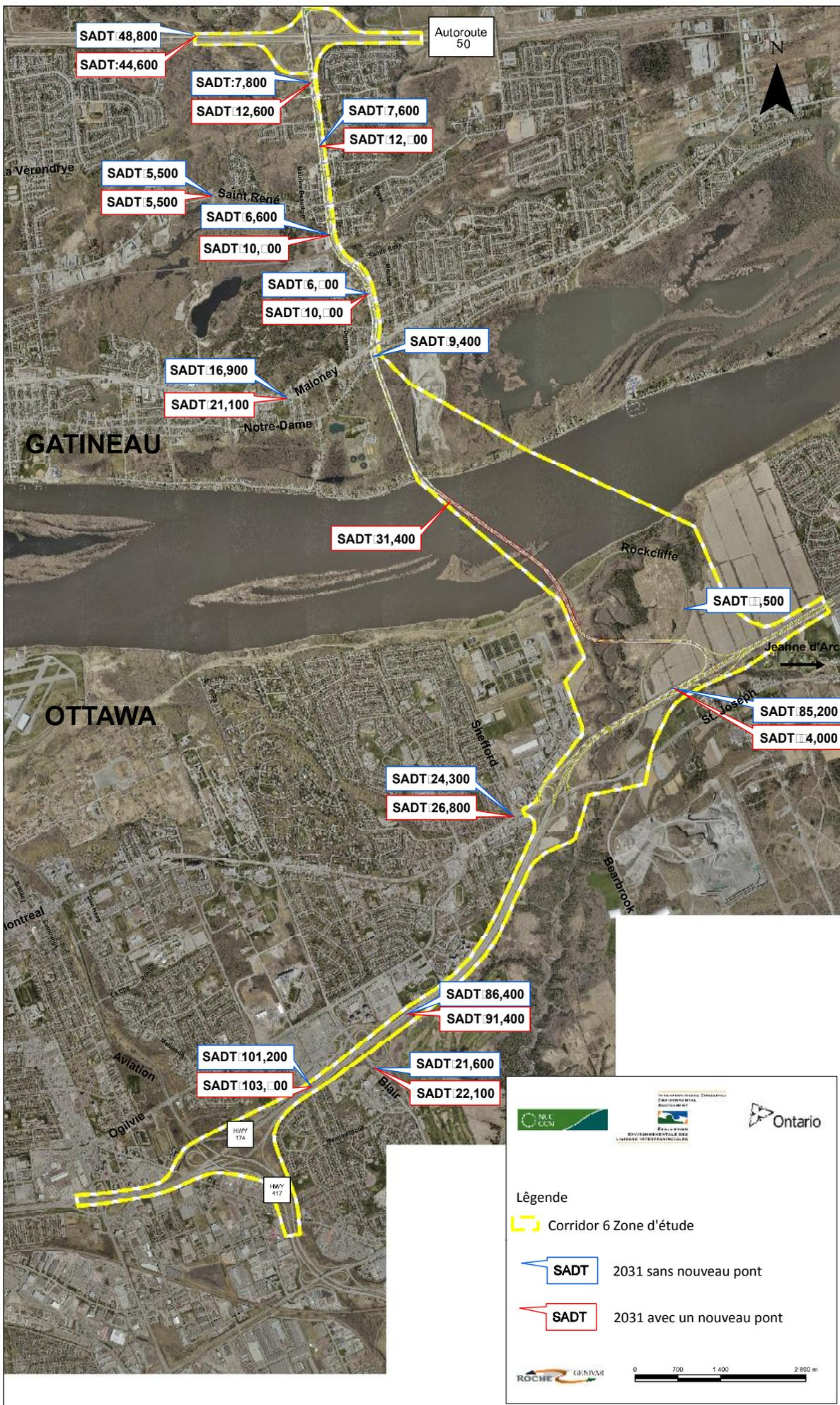
Figure F5: Débits de circulation en section courante, Corridor 6 avec et sans nouveau pont, projection 2031
