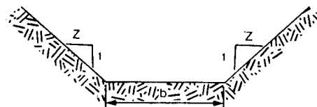
-Vue transversale du déversoir en terre à la section de contrôle
