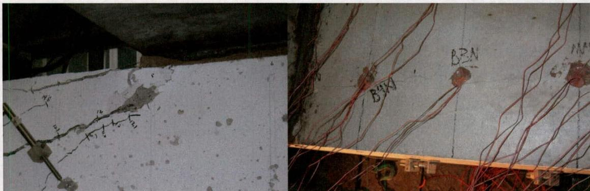
Figure 23 : Compression du béton et fissure traversant les renforcements (1Ba)
