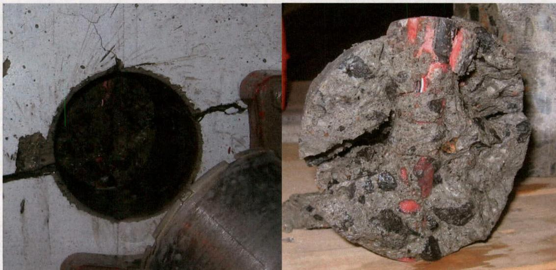
Figure 16 : Carotte de la barre R3WS, dalle 2Ba
