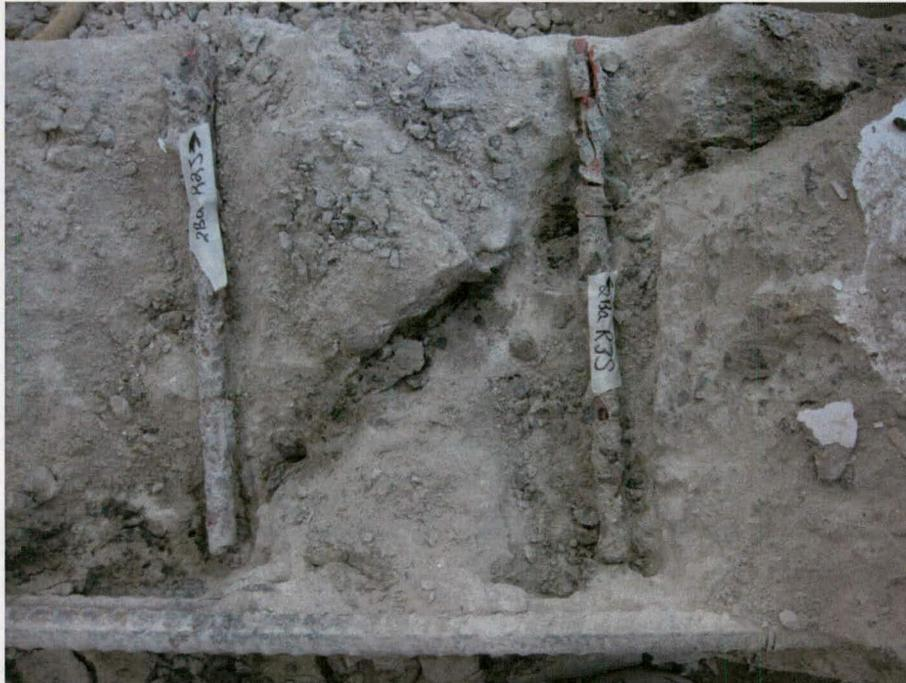
Figure : 19 Vue rapprochée de la face sud de la dalle 2Ba suite à l'extraction des barres
