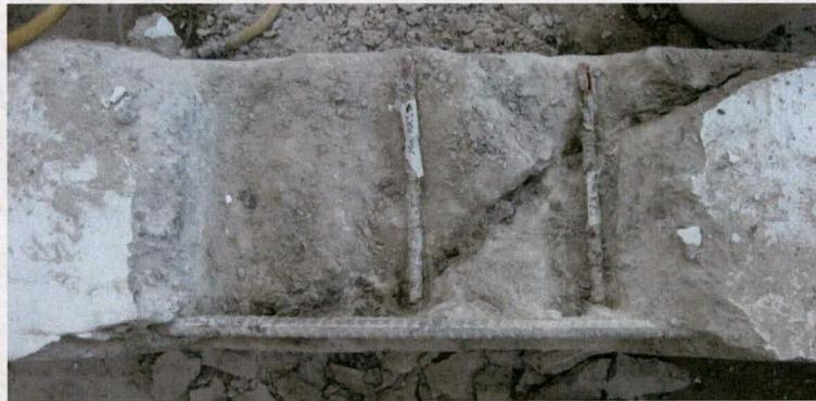
Figure : 18 Vue de la face sud de la dalle 2Ba suite à l'extraction des barres
