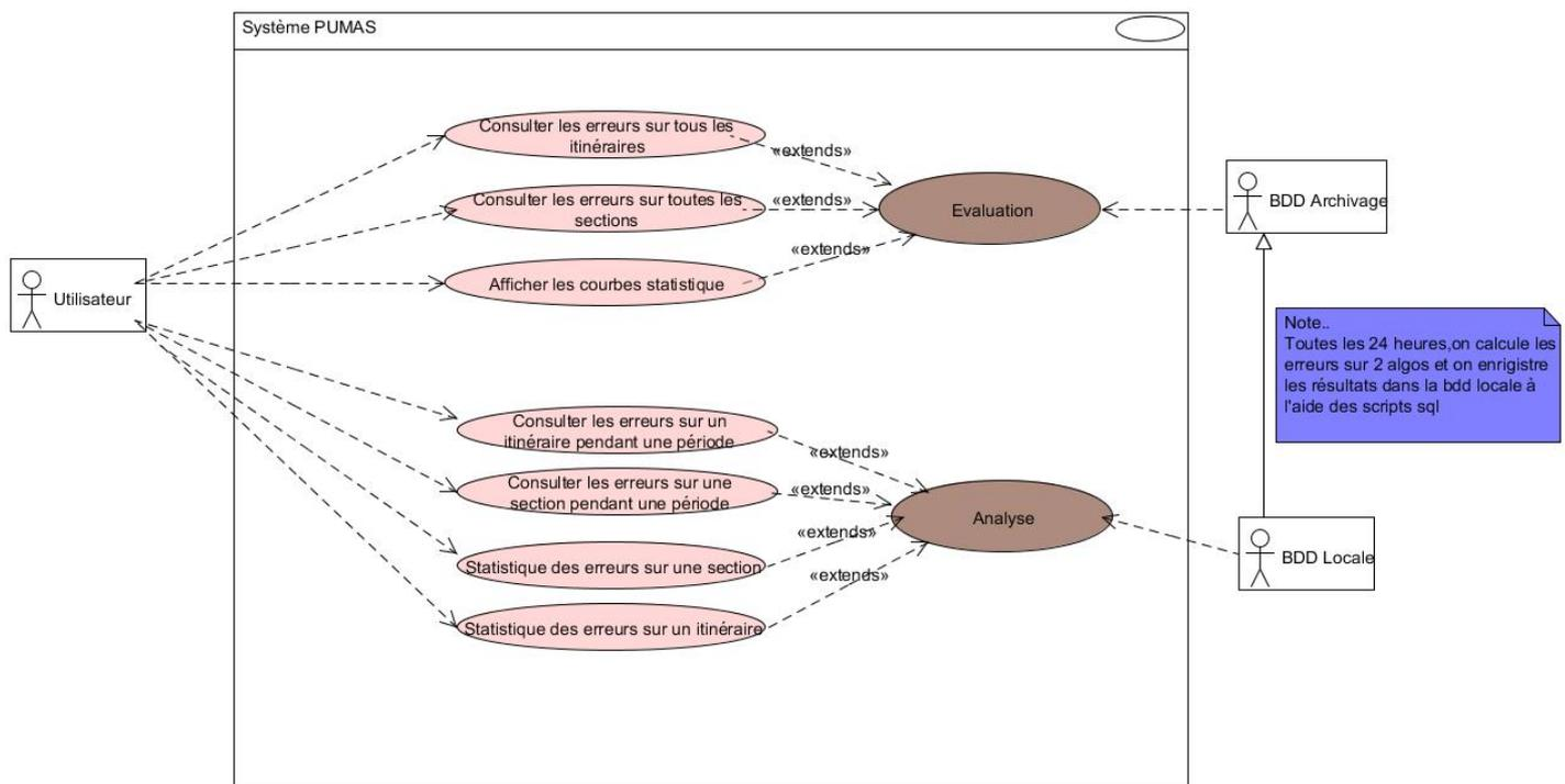
Diagramme de cas d'utilisation pour le sous-système évaluation et analyse
