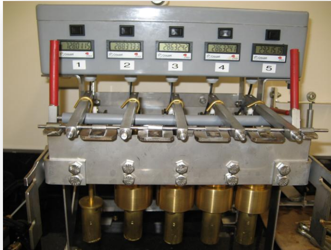
Figure 8 : Dispositif utilisé pour le test de NCLS
