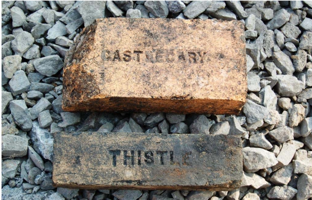
Photo 22 Briques, de type réfractaire, fabriquées en Écosse (PATR12N06-130)
