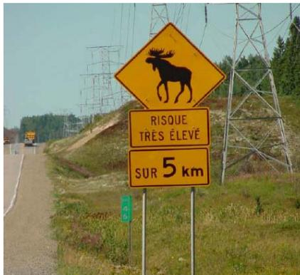
Figure 9 - Panneau indiquant un secteur largement fréquenté par l'orignal en plus de spécifier le niveau de risque et la longueur de la zone impliquée (source : deBellefeuille et Poulin 2003).
